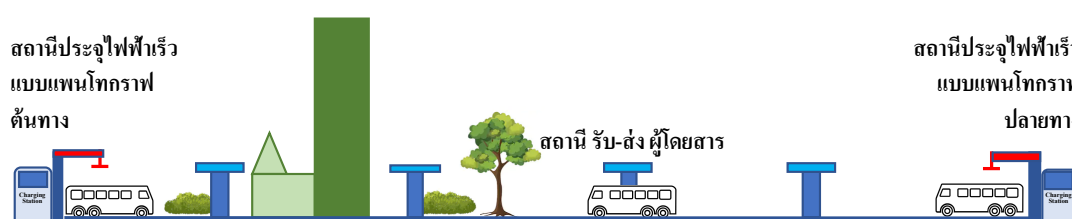
รูปที่ 3.14 แบบจำลองกลยุทธ์การประจุไฟฟ้าเร็วแบบแผนโทกราฟ
