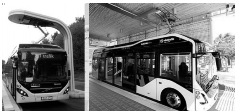
รูปที่ 2.19 สถานีชาร์จหัวชาร์จแบบแพนโทกราฟ Off-board top-down ของบริษัท Siemens 8
