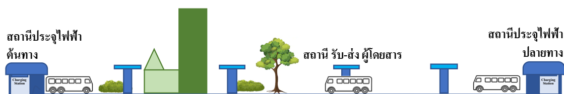
รูปที่ 3.13 แบบจำลองกลยุทธ์การประจุไฟฟ้าแบบทั่วไป สำหรับรถโดยสารไฟฟ้าแบบปลั๊กอิน
