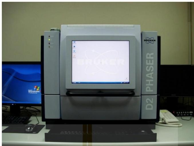
**Figure 3.18** BRUKER D2 PHASER XRD.
