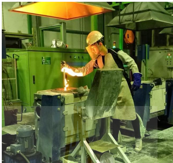
รูปที่ 3.18 การหลอมเหล็กและปรุงส่วนผสมทางเคมี
