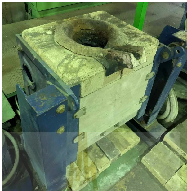
รูปที่ 3.3 เตาหลอมและตู้ควบคุมการดำเนินการ
