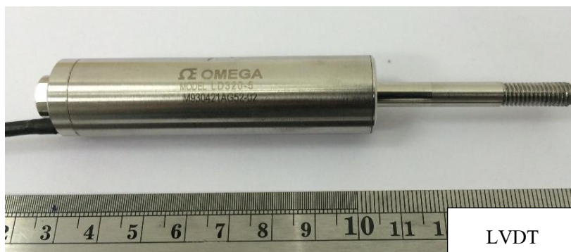
รูปที่ 3.12 เซ็นเซอร์ตำแหน่งเชิงเส้น (Linear Variable Differential Transformer, LVDT)
