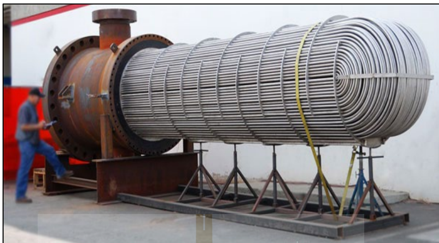
รูปที่ 3.10 Shell and Tube heat exchanger (Michaela Schwandt, 2019)
