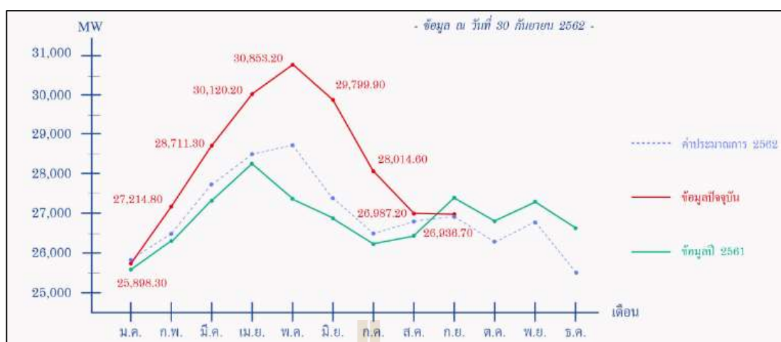
รูปที่ 2.1 ความต้องการพลังไฟฟ้าสูงสุดของระบบ ตั้งแต่เดือนมกราคม ถึง กันยายน 2562 (แหล่งที่มา กองสื่อสารภายนอก ฝ่ายสื่อสารและประชาสัมพันธ์องค์กร กฟผ.)
