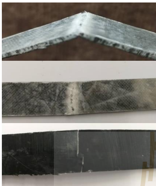
ก) ขนาดอนุภาค 108 ไมโครเมตร น้ำหนัก 350 กรัมต่อตารางเมตร
