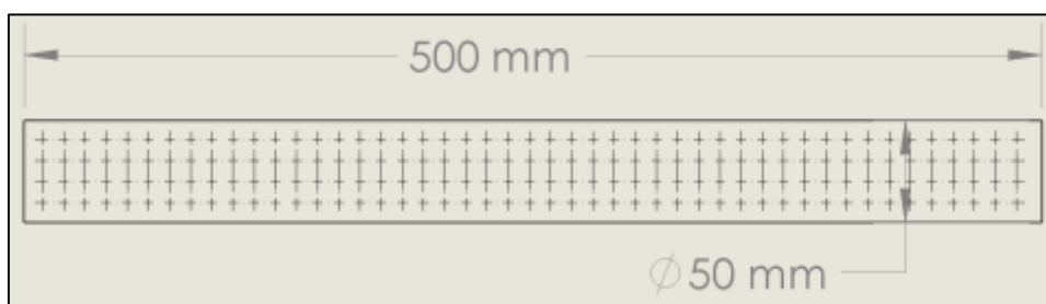
รูปที่ 4.7 ขนาดแผ่นอิเล็กทรอนิกส์
