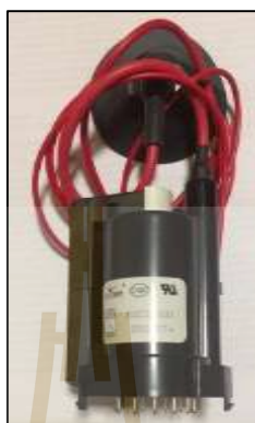
รูปที่ 4.27 หม้อแปลงไฟฟ้าความถี่สูงแบบฟลายแบค
