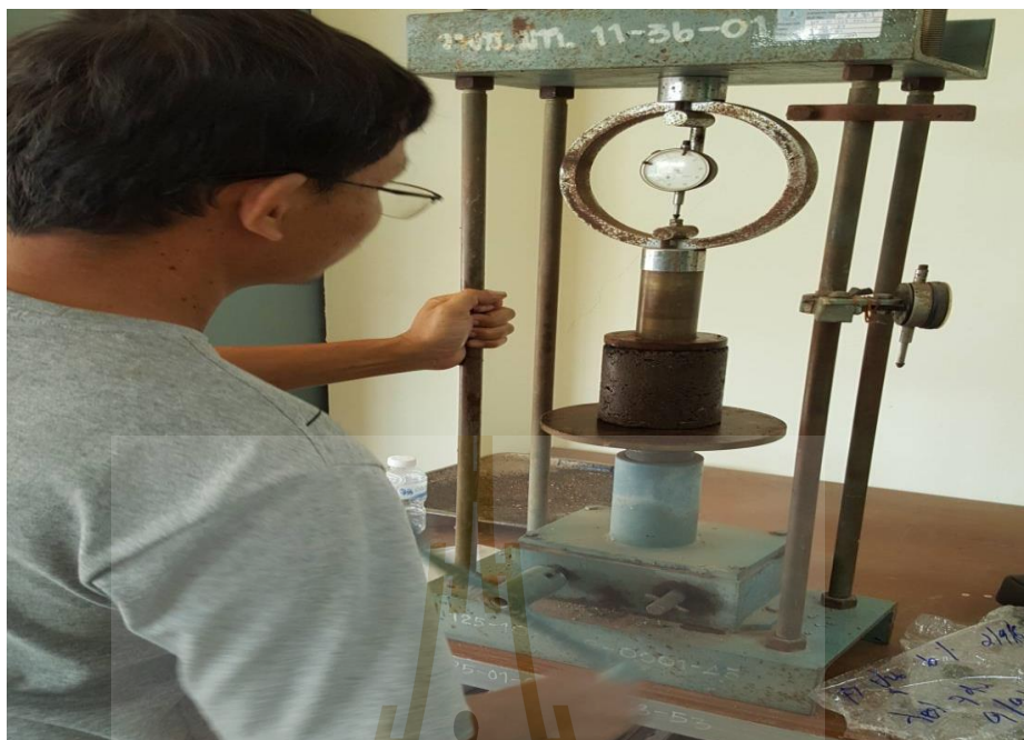
รูปที่ ก.7 ทดสอบกำลังอัดก้อน UNCONFINED COMPRESSIVE STRENGTH (UCS)
