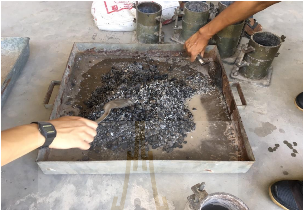
รูปที่ ก.3 RAP ที่จัดเตรียมให้เป็น Gradation ผสมกับปูนซีเมนต์ปอร์ตแลนด์
