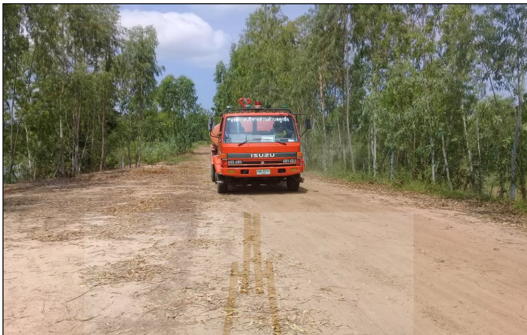
รูปที่ ก.5 การทดสอบวิ่งรถดับเพลิง ผิวทางลูกรัง
