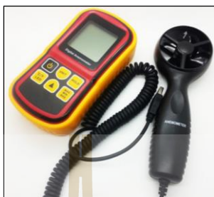
รูปที่ 8.1 เครื่องวัดความเร็วลมมือถือ BENETECH รุ่น GM8901
