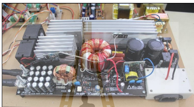
รูปที่ 4.11 แหล่งจ่ายกำลังไฟฟ้าสวิตซิง
