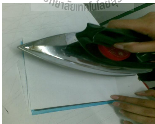
รูปที่ 3.17 ใช้เตารีดรีดแผ่นทองแดงที่ติด Dry film แล้ว
