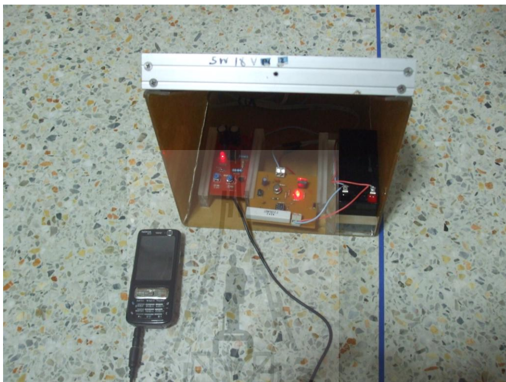
รูปที่ 4.6 แสดงการทำงานของวงจรชาร์ตแบตเตอรี่สำหรับโทรศัพท์มือถือ
