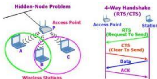
รูปที่ 2.10 Hidden Node Problem และ กลไก RTS/CTS Handshake
