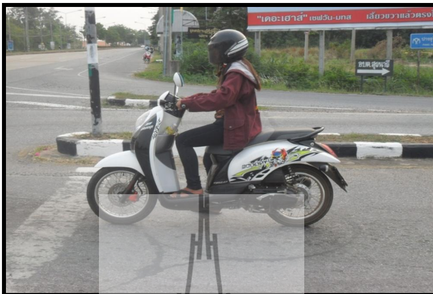
รูปที่ 4.9 ลักษณะยานพาหนะขนาดเล็กอยู่บนลูบหนี่วนำ
