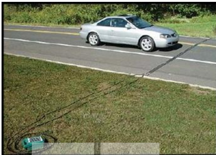
รูปที่ 2.11 การตรวจวัดยานพาหนะโดยใช้ท่อลม
