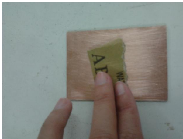
รูปที่ 3.3 การขัดลายวงจรโดยใช้กระดาษทราย
