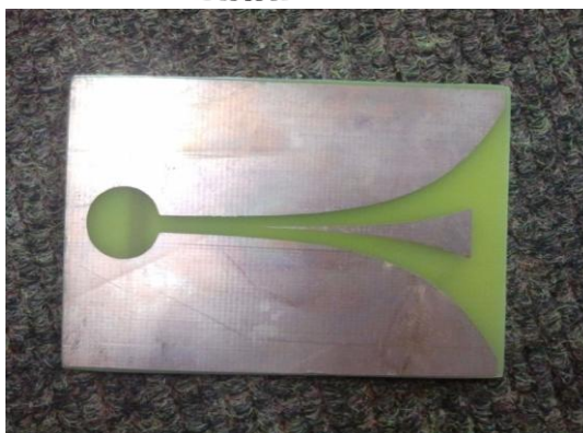
รูปที่ 5.6 สายอากาศวิวลดิหลังจากใช้น้ำยากัดปรีน
