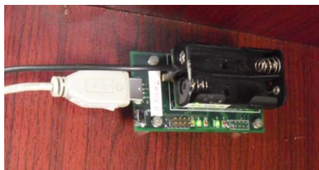
รูปที่3.4 เซ็นเซอร์ที่สถานีฐาน (Base Station)
