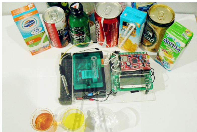
รูปที่ 4.25 เชื่อมต่อสายสัญญาณ (D,S) และขั้วอ้างอิง (G) พร้อมสายสัญญาณ (V+ และ GND) เข้ากับบอร์ด FiO Std
