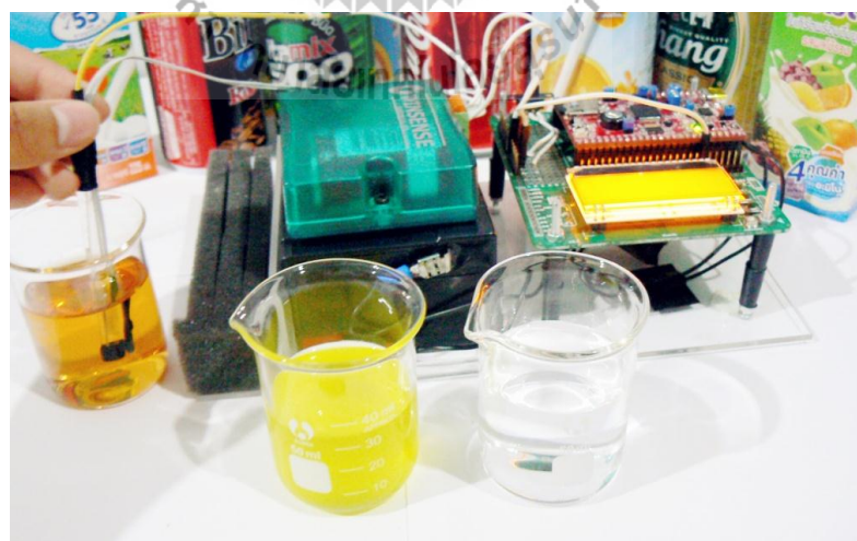
รูปที่ 4.26 การจุ่มโพรบในสารละลายตัวอย่าง แต่ยังไม่ได้เปิดสวิตช์
