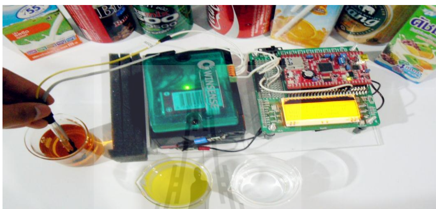
รูปที่ 4.21 การวัดค่า pH ของสารละลายตัวอย่าง
