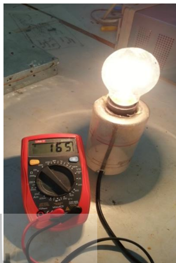
รูปที่ 3.8 ภาพแสดง เอาต์พุต ของวงจรดิโมเมอร์ปรับมูไวที่ 16.5 โวลต์
