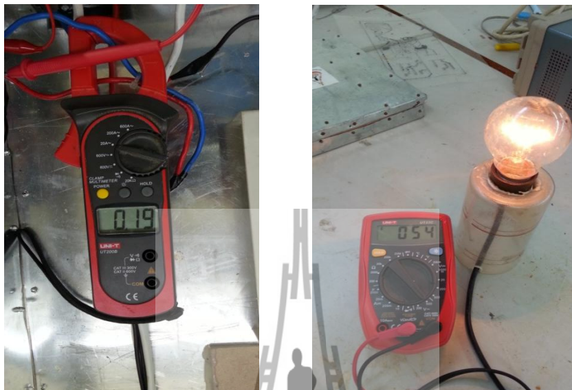
รูปที่ 3.6 ภาพแสดง เอาต์พุต ของวงจรดิมเมอร์ปรับมูมไว้ที่ 54 โวลต์
