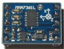
รูปที่ 3.4 เซ็นเซอร์วัดความเร่ง 3 แกน (MMA7361L)
