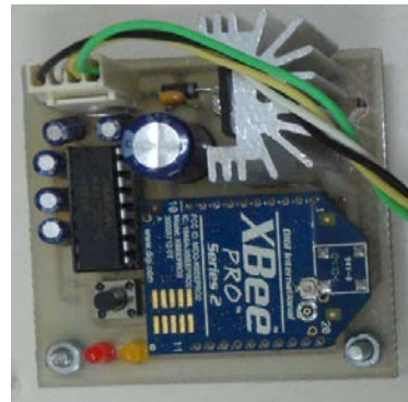
รูปที่ 3.3 โมดูล X-Bee PRO 50mW U.F.L Connection - Series 2 (ZB) (ด้านซ้ายมือ) และ บอร์ดเชื่อมโมดูล X-Bee (ด้านขวามือ)
