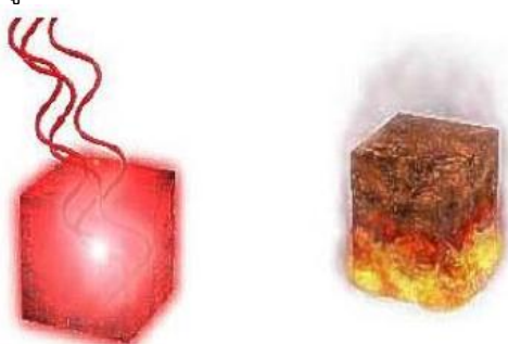
รูปที่2.4 วัสดุที่มีการให้ความร้อนแบบไดอิเล็กทริก (รูปซ้าย) และการให้ความร้อนแบบเดิม (รูปขวา) [2]
