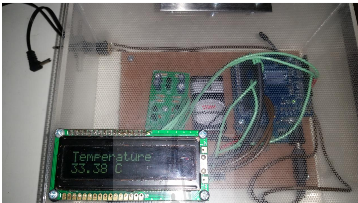
รูปที่ 4.12 ภาครับรับอุณหภูมิจากภายนอกและมีการแจ้งเตือน
