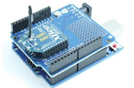
รูปที่2 บอร์ด Arduino ต่อกับบอร์ด XBee Shield
