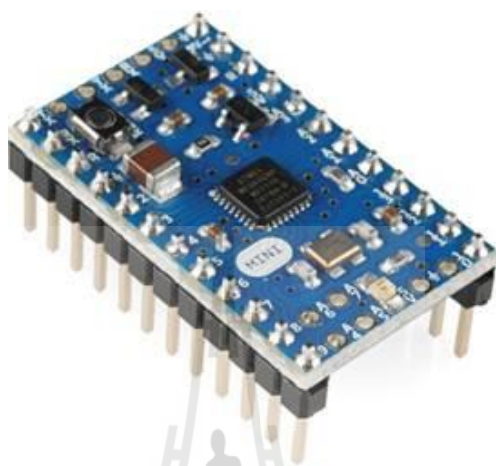
รูปที่ 2.25 Arduino Mini 05
