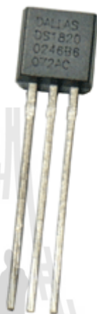
รูปที่ 2.9 เซ็นเซอร์วัดอุณหภูมิรุ่น DS18B20
