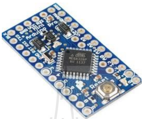
รูปที่ 2.27 Arduino Pro Mini 328 5V
