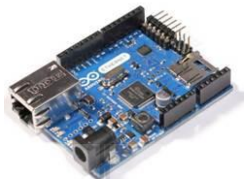
รูปที่ 2.29 Arduino Ethernet without PoE module
