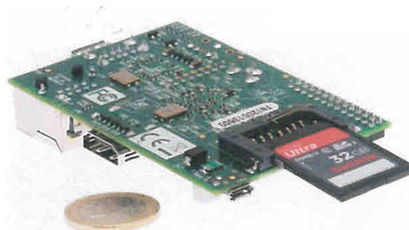
รูปที่3.5 เชื่อมต่อ SD card กับบอร์ด Raspberry Pi [13]
