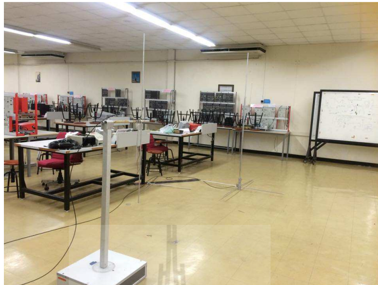
รูปที่ 4.18 การวัดอัตราขยายของสายอากาศโมโนโพลความยาว 5\lambda/8
