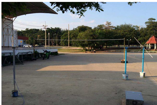
รูปที่ 4.11 วิธีวัดแบบระนาบสนามไฟฟ้าของสายอากาศต้นแบบ
