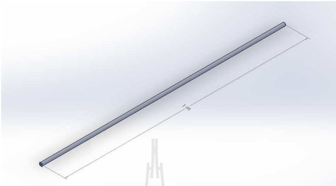
รูปที่ 3.40 ชิ้นส่วนและขนาดสายอากาศส่วนที่ 1
