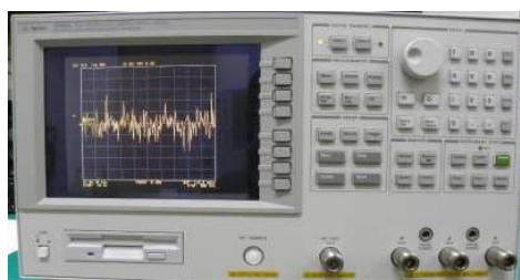
รูปที่ 4.8 เครื่องวิเคราะห์แถบคลื่นสัญญาณ (spectrum analyzer)
