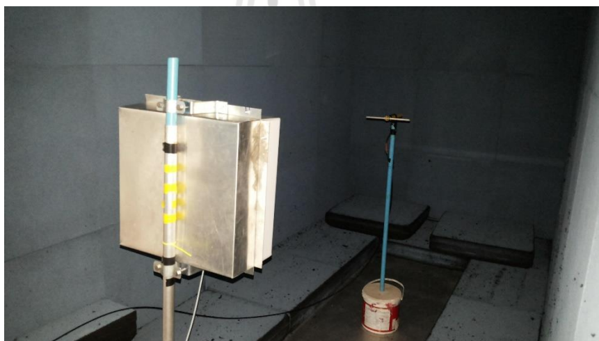
รูปที่ 4.4 ระยะห่างระหว่างสายอากาศภาคส่งและสายอากาศภาครับ
