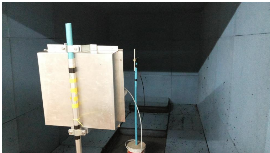
รูปที่ 4.5 การวัดแบบรูปการแผ่กำลังในระนาบสนามแม่เหล็ก
