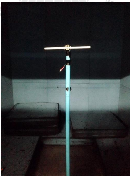
รูปที่ 4.11 สายอากาศไดโพลความยาวครึ่งคลื่นที่ใช้เป็นสายอากาศภาคส่ง
