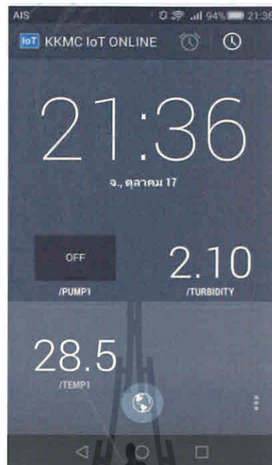
รูปที่ 4.11 ค่าพารามิเตอร์ของเซนเซอร์และแสดงสถานะปิดการทำงานของกังหันน้ำ ขั้นตอนที่ 10 ทดสอบแสดงค่าพารามิเตอร์ของเซนเซอร์ และสั่งปิดมอเตอร์บน NETPIE
