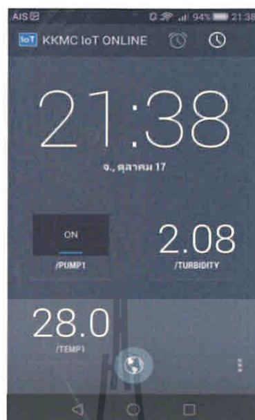
รูปที่ 4.9 ค่าพารามิเตอร์ของเซนเซอร์และแสดงสถานะเปิดการทำงานของกังหันน้ำ ขั้นตอนที่ 8 ทดสอบแสดงค่าพารามิเตอร์ของเซนเซอร์ และสั่งเปิดมอเตอร์กังหันน้ำบน
