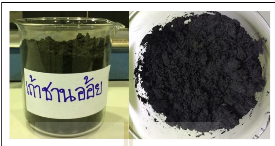
รูปที่ 2.22 ถ่านอ้อยที่เหลือจากการเผาเป็นเชื้อเพลิง
