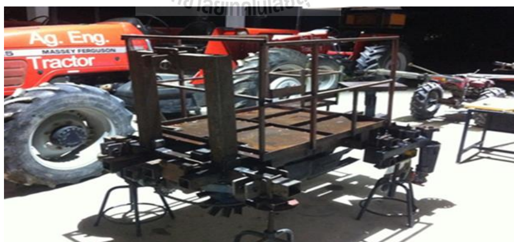
รูปที่ 4.4 แสดงเครื่องปลูกมันสำปะหลังโดยรวม
