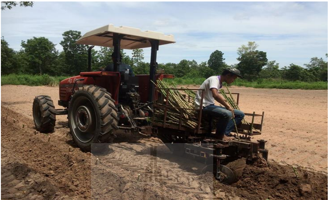
รูปที่ ข.1 การทดสอบเครื่องปลูกมันสำปะหลังในแปลงทดสอบ
