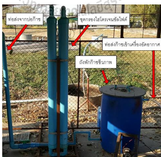
รูปที่ 4.3 ระบบทำความสะอาดก๊าซชีวภาพ
