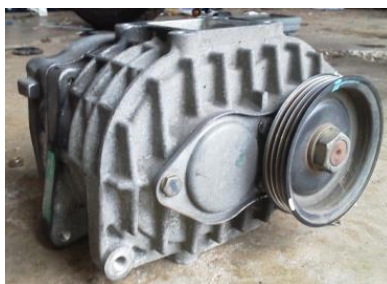
รูปที่ 4.7 เครื่องอัดอากาศ Roots blower
