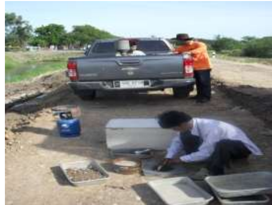
รูปที่ 4.14 ข. การทดสอบความแน่นในสนามของดินลูกรัง
