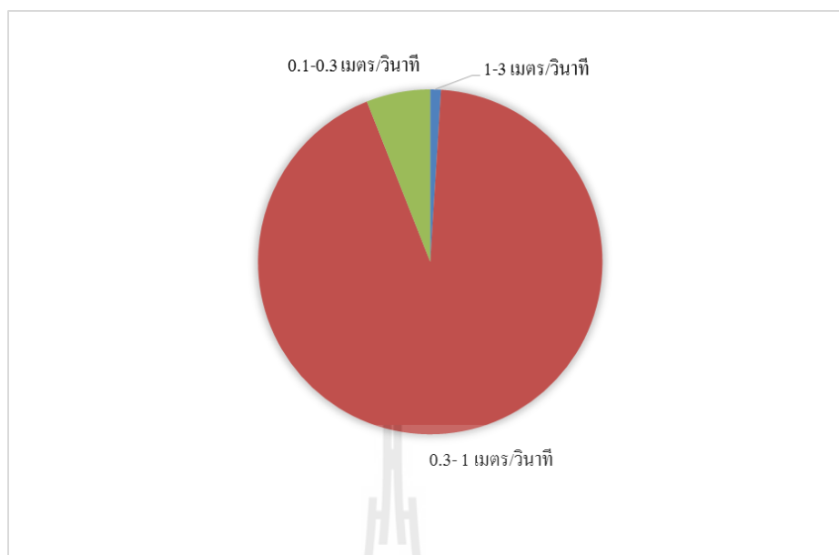
รูปที่ 4.18 ผลความเร็วของน้ำในช่วงต่างๆในเส้นท่อจ่ายน้ำจากแบบจำลอง
