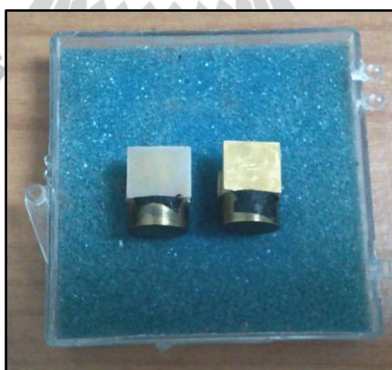
รูปที่ 4.7 วัสดุเซรามิก PZT ก่อนและหลังทำอิเล็กโทรด
