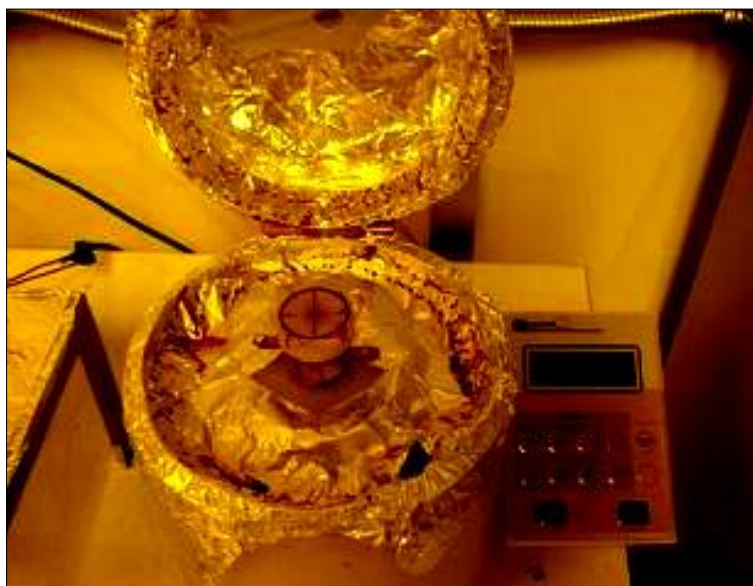
รูปที่ 3.6 ลักษณะภายในของเครื่องหมุนเคลือบสารไวแสง
