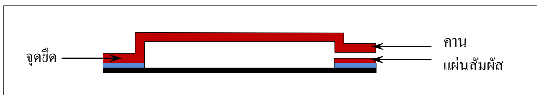
รูปที่ 2.1 โครงสร้างคานจุลภาคของ Wolf et al. (1972)
