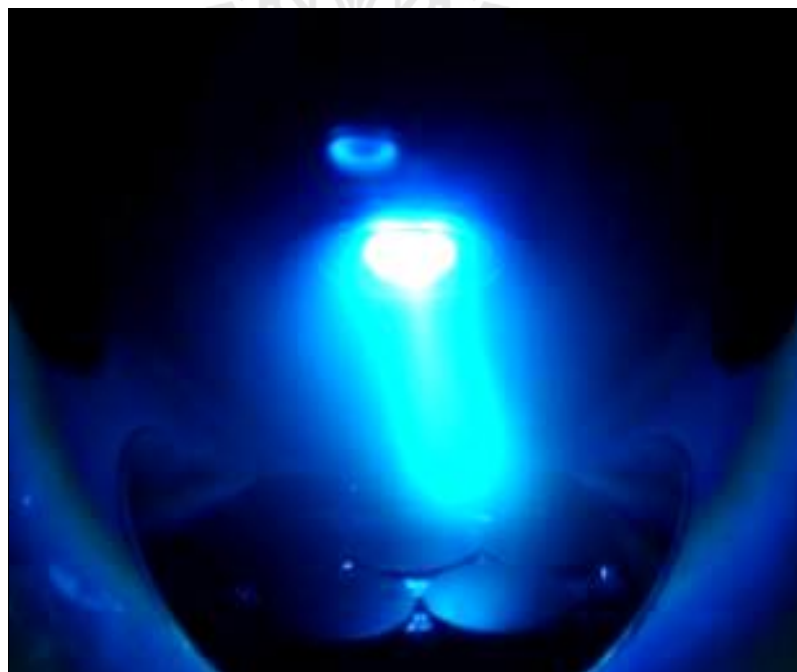
รูปที่ 3.5 ลำแสงพลาสมาจากเครื่องสเปคเตอรืง
