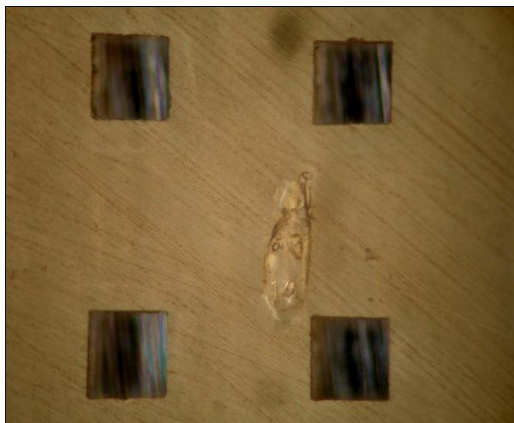
รูปที่ 5.5 ช่องสี่เหลี่ยมภายในแม่พิมพ์สารไวแสง SU-8 ความหนาประมาณ 500 \mu\text{m}
