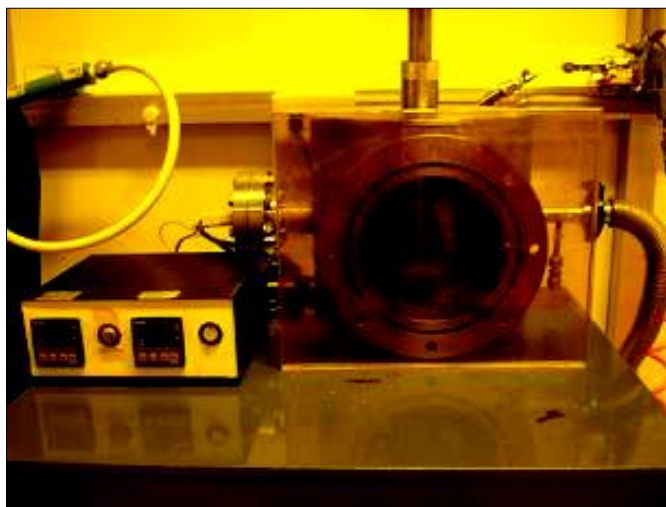
รูปที่ 3.11 ห้องสุญญากาศที่ใช้ในการเตรียมฟิล์มบางของ SU-8 จากการเทหล่อผง SU-8
