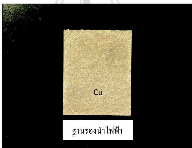
รูปที่ 5.16 วัสดุชิ้นชั่วคราวหลังจากเดิมทองแดงด้วยไฟฟ้าแล้วที่ใช้หนุรอง ได้ก่อนมวลของสวิตซ์ความเร่ง
