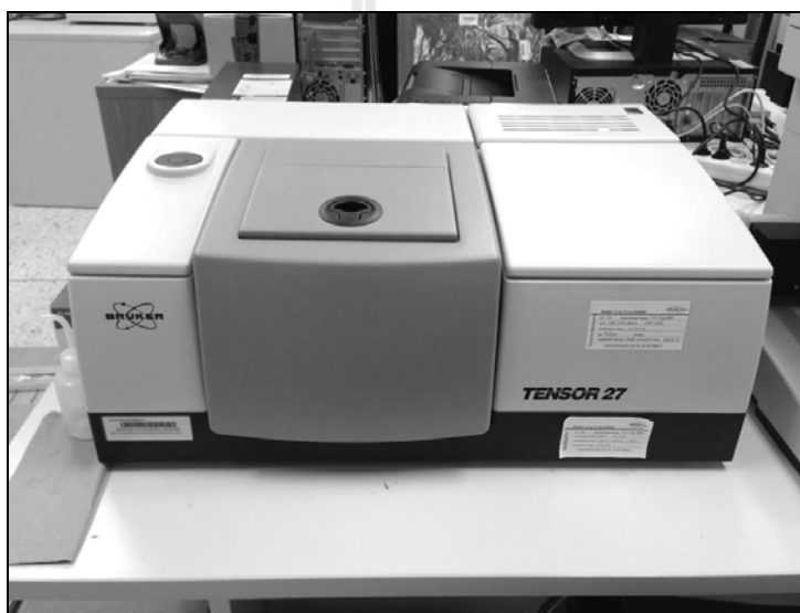
รูปที่ 3.23 เครื่องวิเคราะห์ ATR-FTIR ของบริษัท BRUKER รุ่น TENSOR 27
