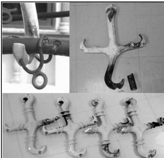
รูปที่ 1.2 เคเบิลสเปเซอร์ชนิดเซรามิกเสื่อมสภาพจากการใช้งาน (ที่มา: อ้นชูริย์พร เชอสินธุ์, ม.ป.ป.)
