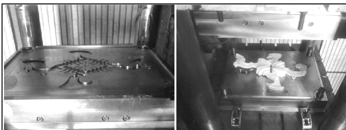
รูปที่ 3.4 แม่พิมพ์ที่ใช้ขึ้นรูปเคเบิลสเปเซอร์
