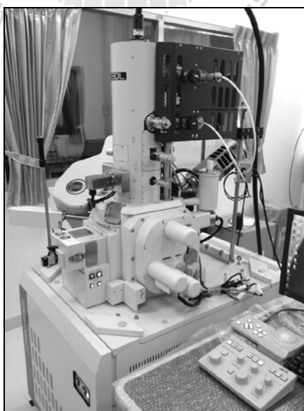
รูปที่ 3.21 กล้องจุลทรรศน์อิเล็กตรอนแบบส่องกราด JEOL รุ่น JSM – 7800F
