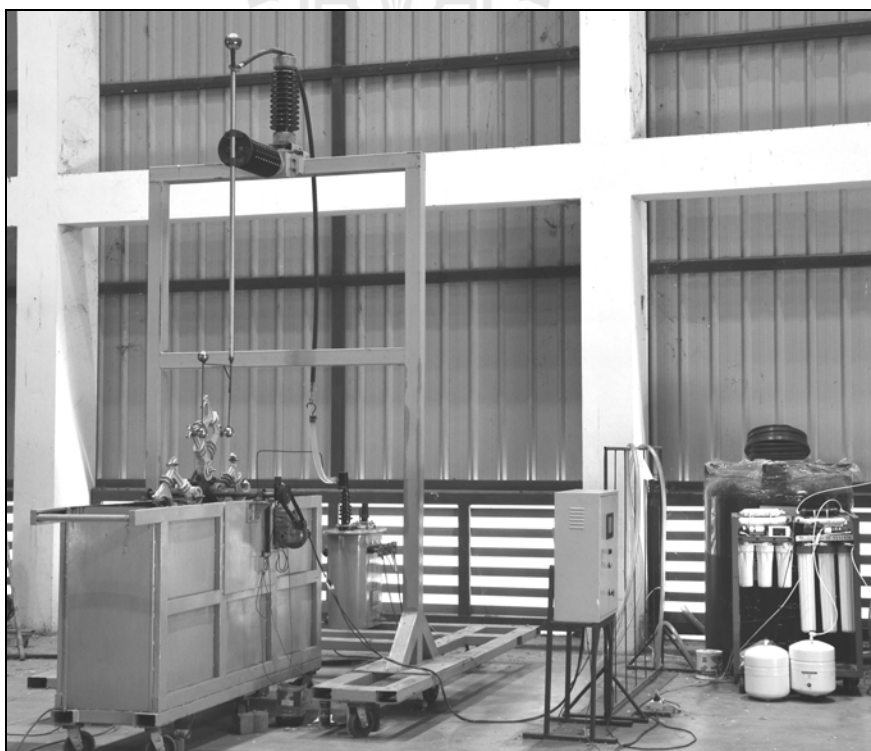
รูปที่ 4.25 ชุดทดสอบการเสื่อมอายุแบบวงล้อจุ่มน้ำเกลือ
