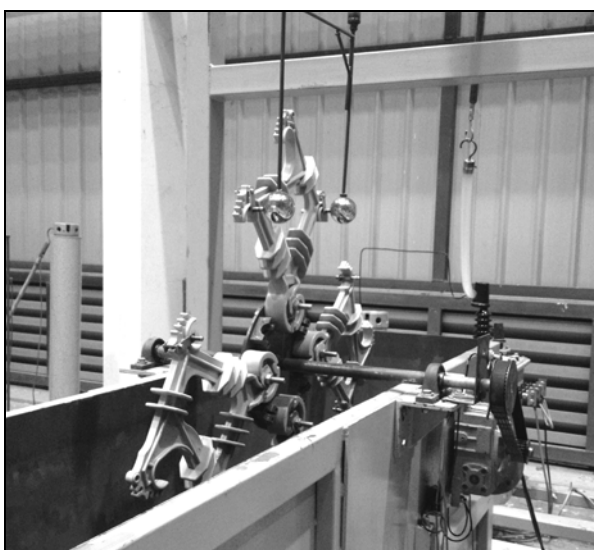
รูปที่ 4.22 ลักษณะการติดตั้งเคเบิลสเปเซอร์บนเพลา
