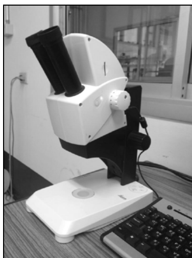
รูปที่ 3.19 กล้องจุลทรรศน์แบบสเตอริโอ LEICA รุ่น EZ4D
