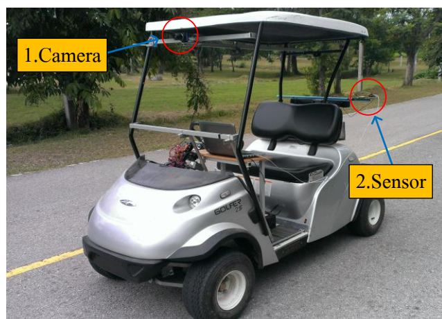
รูปที่ 3.1 ยานพาหนะต้นแบบที่ใช้ในงานวิจัย
