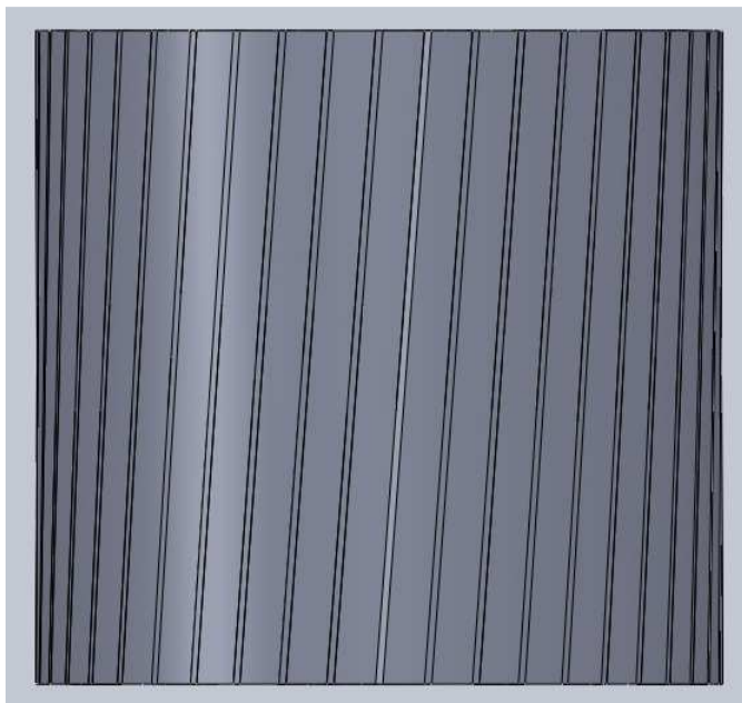
รูปที่ 3.18 การวางตัวของร่องโรเตอร์แบบเฉียงเต็มร่อง
