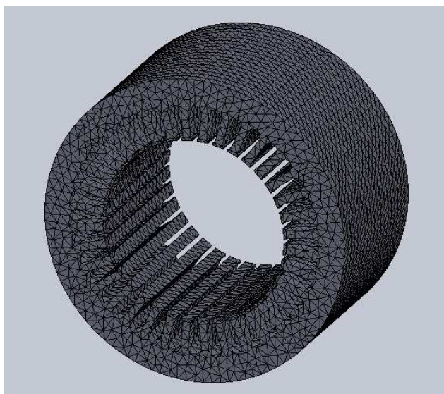
รูปที่ 5.1 การแบ่งอิลลิเมนต์และจุดต่อของมอเตอร์เพื่อคำนวณการสั่นสะเทือน
