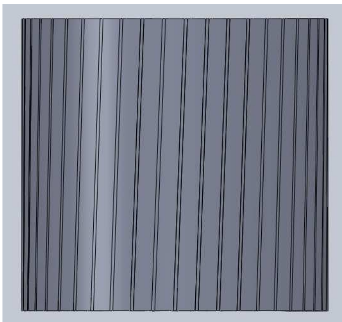
รูปที่ 3.16 การวางตัวของร่องโรเตอร์แบบเฉียงครึ่งร่อง
