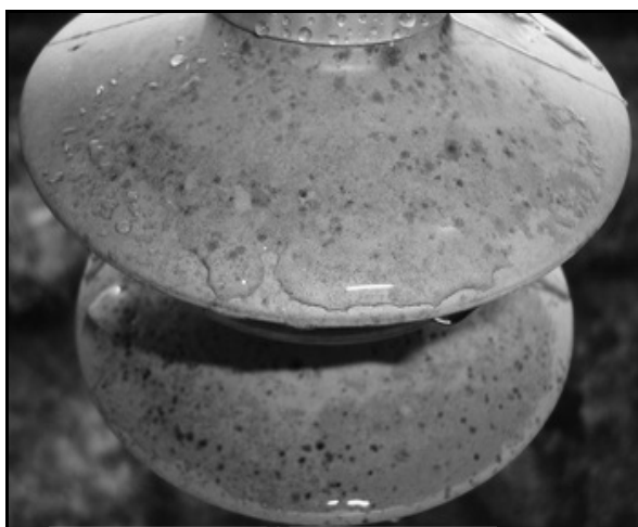
รูปที่ 6.17 ลักษณะคุณสมบัติผิวหยดน้ำลื่นของลูกถ้วยฉนวนพอลิเมอร์ปีกสลับ-เอียงชนิดอ่อน หลังได้รับแสงแดด 2 ปี
