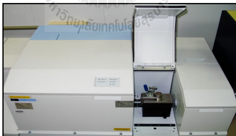
รูปที่ 6.37 ลักษณะของเครื่องมือที่ใช้วิเคราะห์ฉนวนยางซิลิโคนด้วยเทคนิค ATR-FTIR
