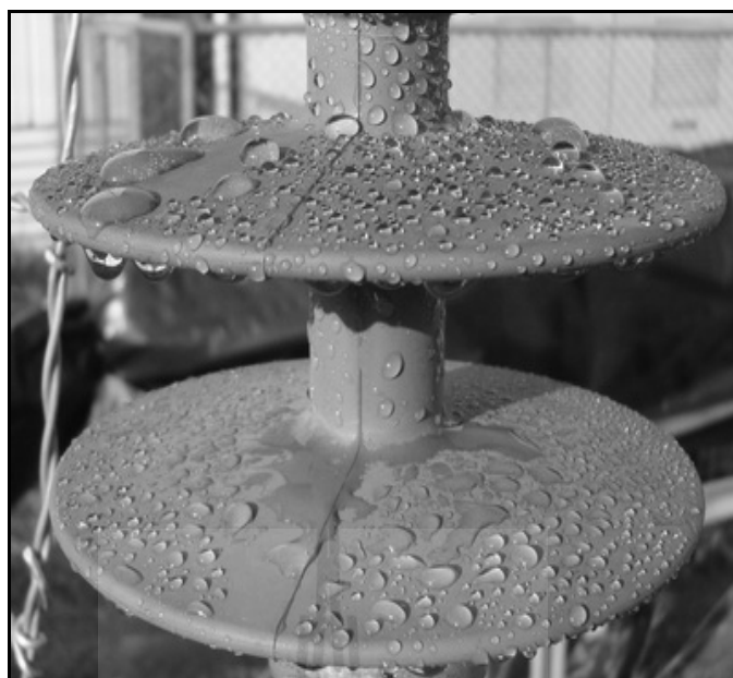
รูปที่ 6.15 ลักษณะคุณสมบัติผิวหยดน้ำลื่นของลูกถ้วยฉนวนพอลิเมอร์ปีกตรง หลังได้รับแสงแดด 2 ปี
