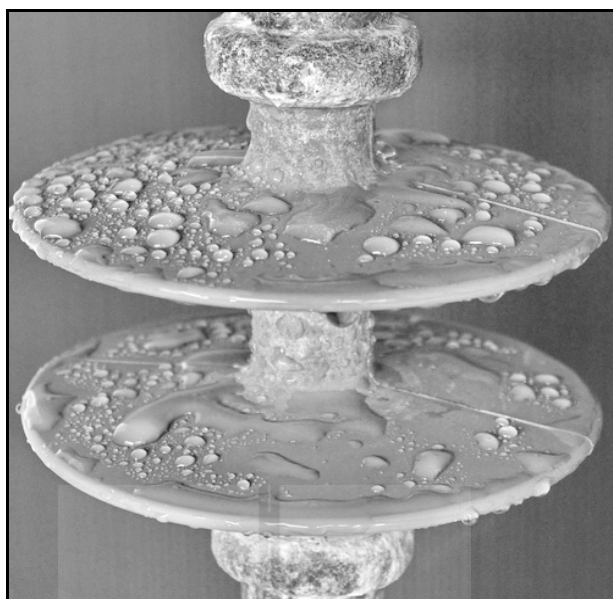
รูปที่ 6.10 ลักษณะคุณสมบัติผิวหยดน้ำลื่นของลูกถ้วยฉนวนพอลิเมอร์ปีกตรง หลังทดสอบหมอกไอเกลือ
