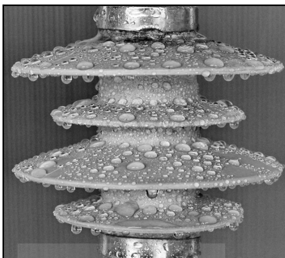
รูปที่ 6.12 ลักษณะคุณสมบัติผิวหยดน้ำลื่นของลูกถ้วยฉนวนพอลิเมอร์ปีกสลับ-เอียงชนิดอ่อน หลังทดสอบหมอกไอเกลือ
