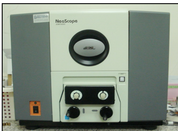
รูปที่ 6.21 กล้องจุลทรรศน์อิเล็กตรอนแบบส่องกราดรุ่น NeoScope JCM-5000
