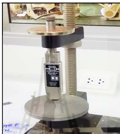
รูปที่ 6.35 เครื่องมือสำหรับวิเคราะห์ค่าความแข็งของฉนวนยางซิลิโคน
