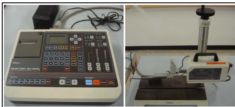
รูปที่ 6.36 ลักษณะของเครื่องวัดค่าความขรุขระของฉนวนยางซิลิโคน
