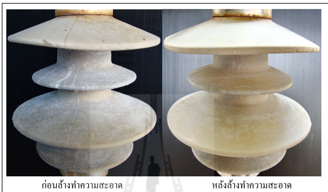
(ก) ลักษณะลูกถ้วยฉนวนพอลิเมอร์ปีกลับ-เอียงชนิดแข็งหลังการทดสอบหมอกไอเกลือ
