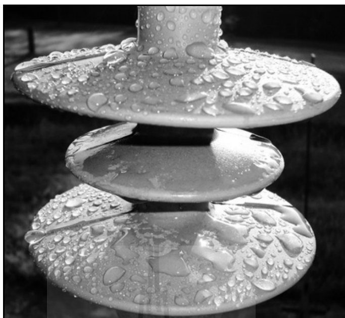
รูปที่ 6.16 ลักษณะคุณสมบัติผิวหยดน้ำลื่นของลูกถ้วยฉนวนพอลิเมอร์ปีกสลับ หลังได้รับแสงแดด 2 ปี
