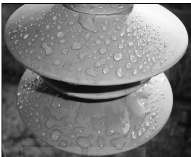
รูปที่ 6.18 ลักษณะคุณสมบัติผิวหยดน้ำลื่นของลูกถ้วยฉนวนพอลิเมอร์ปีกสลับ-เอียงชนิดแข็ง หลังได้รับแสงแดด 2 ปี
