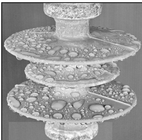
รูปที่ 6.11 ลักษณะคุณสมบัติผิวหยดน้ำลื่นของลูกถ้วยฉนวนพอลิเมอร์ปีกสลับ หลังทดสอบหมอกไอเกลือ
