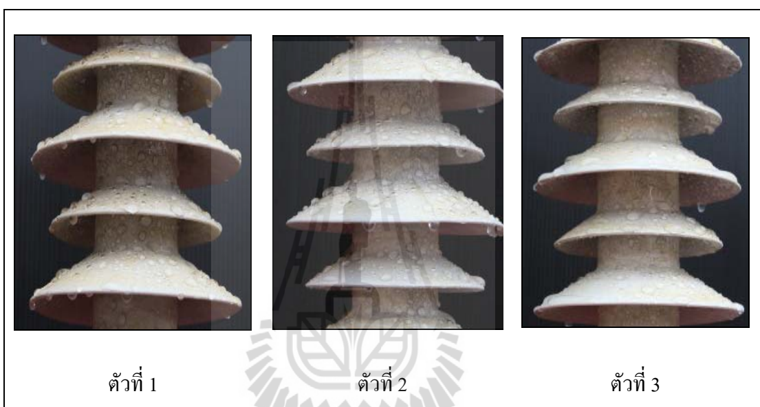
รูปที่ 6.7 ลักษณะผิวหยดน้ำขึ้นบนผิวฉนวนยางซิลิโคนจากการทดสอบรอบที่ 2
