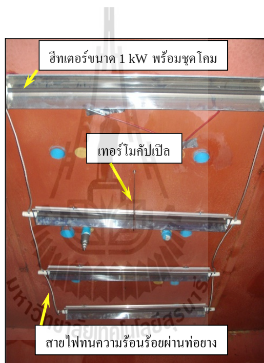
รูปที่ 4.15 ฮีตเตอร์อินฟราเรดพร้อมชุดโคมและเทอร์โมคัปเปิลที่ติดตั้ง
