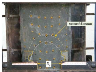
รูปที่ 11 รูปแบบการวิบัติของตัวอย่างที่สังเกตพบ (ระยะ S_g / B = 1.2 )
