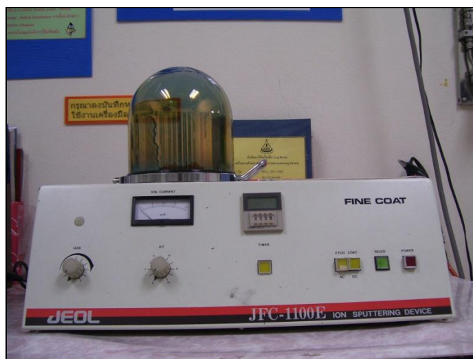
รูปภาคผนวกที่ 2 เครื่อง ion sputtering รุ่น JFC-1100E ของ JEOL ที่ใช้เคลือบผิวตัวอย่างแบบเหรียญ ด้วยทองที่ศูนย์เครื่องมือวิทยาศาสตร์และเทคโนโลยี มหาวิทยาลัยเทคโนโลยีสุรนารี
