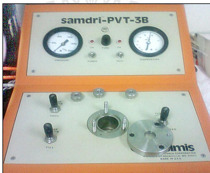
รูปภาคผนวกที่ 3 เครื่องทำแห้ง ณ จุดวิกฤต (critical point drier) ที่ใช้ทำให้ตัวอย่างแห้งโดยที่รูปร่าง และโครงสร้างเหมือนกับธรรมชาติ ที่ศูนย์เครื่องมือวิทยาศาสตร์และเทคโนโลยี มหาวิทยาลัยเทคโนโลยีสุรนารี
