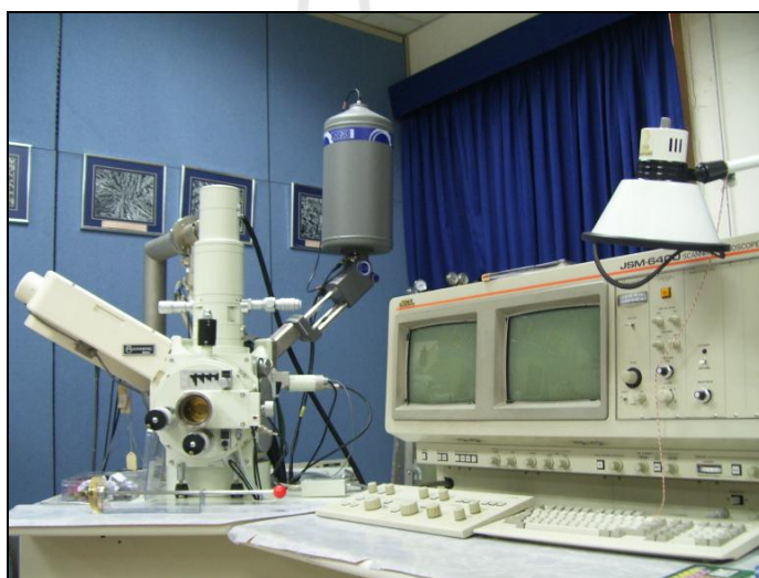
รูปภาคผนวกที่ 1 กล้องจุลทรรศน์อิเล็กตรอนแบบส่องกราด รุ่น JSM - 6400 ของ JEOL ที่ศูนย์เครื่องมือวิทยาศาสตร์และเทคโนโลยี มหาวิทยาลัยเทคโนโลยีสุรนารี
