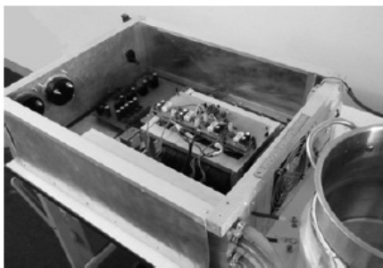
รูปที่ 6 เครื่องให้ความร้อนแบบเหนี่ยวนำความถี่สูง
