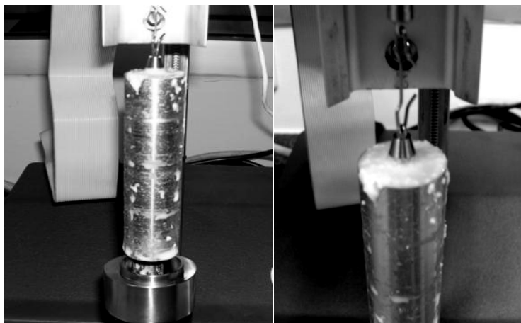
ภาพที่ 4.5 การเกิดผลึกในระหว่างวัดความหนืดที่อุณหภูมิ 5 องศาเซลเซียสของระบบอิมัลชันที่มีอิมัลซิไฟเออร์ชนิด GMO ที่ระดับความเข้มข้นร้อยละ 1 โดยน้ำหนัก
