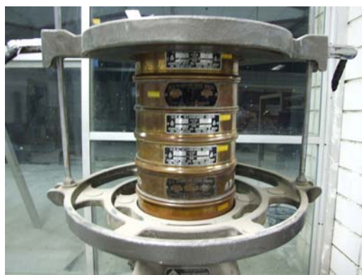
รูปที่ 3.3 การทดสอบการหาขนาดละเอียดของทราย
