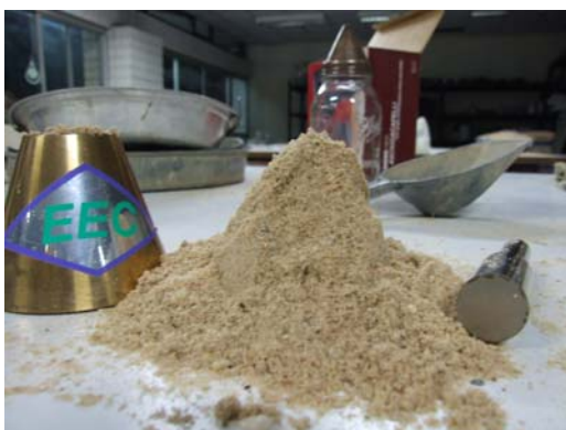
รูปที่ 3.2 การทดสอบหาความถ่วงจำเพาะและค่าการดูดซึมน้ำของทราย
