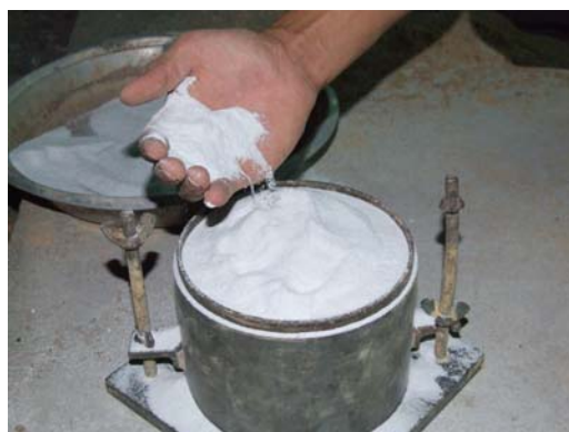
รูปที่ 3.5 การทดสอบหาค่าความถ่วงจำเพาะและหน่วยน้ำหนักของไคอะตอมไมท์และเพอร์ไลต์
