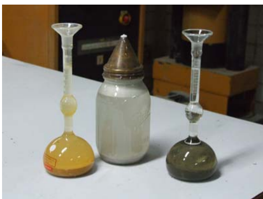
รูปที่ 3.5 การทดสอบหาค่าความถ่วงจำเพาะและหน่วยน้ำหนักของไคอะตอมไมท์และเพอร์ไลต์
