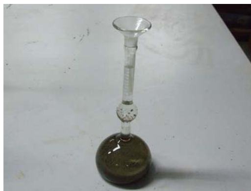
รูปที่ 3.4 การทดสอบหาค่าความถ่วงจำเพาะของปูนซีเมนต์
