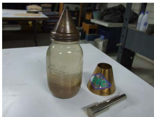
รูปที่ 3.2 การทดสอบหาความถ่วงจำเพาะและค่าการดูดซึมน้ำของทราย
