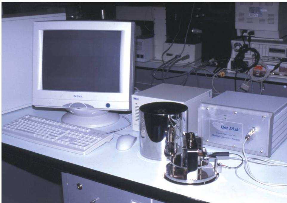
**Figure 3.11** Thermal Constants Analyser (Hot Disk).
