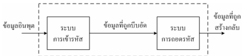
รูปที่ 3.5 รูปแบบการเข้ารหัสและถอดรหัส CODEC
