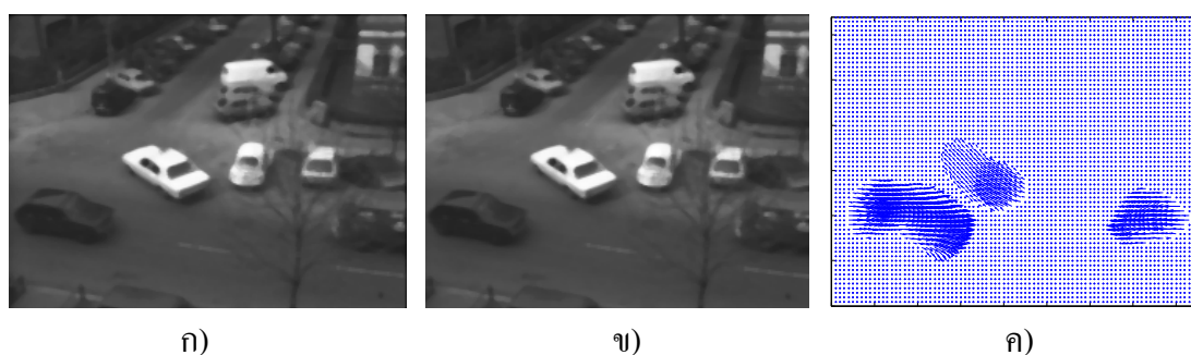
รูปที่ 3.9 ผลจากการหาการไหลของแสงด้วยวิธีของ Lucas & Kanade ก) ลำดับภาพ Hamburg Taxi ลำดับที่ n-1 ข) ลำดับภาพ Hamburg Taxi ลำดับที่ n ค) ผลการไหลของแสง
