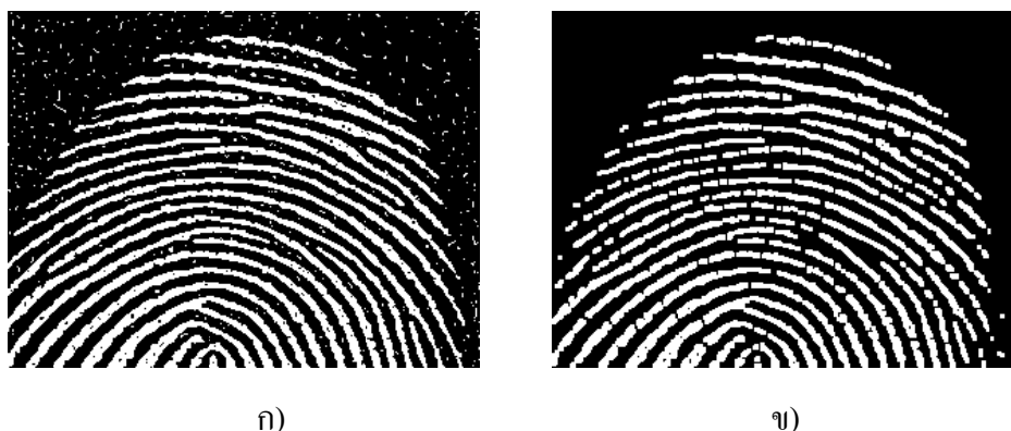
รูปที่ 2.16 ตัวอย่างการเปลี่ยนรูปแบบเปิดของภาพ (1) ก) ภาพต้นแบบ ข) ผลการเปลี่ยนรูปแบบเปิด
