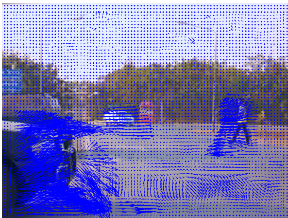
รูปที่ 3.24 การไหลของแสงที่เกิดจากสถานะจริง
