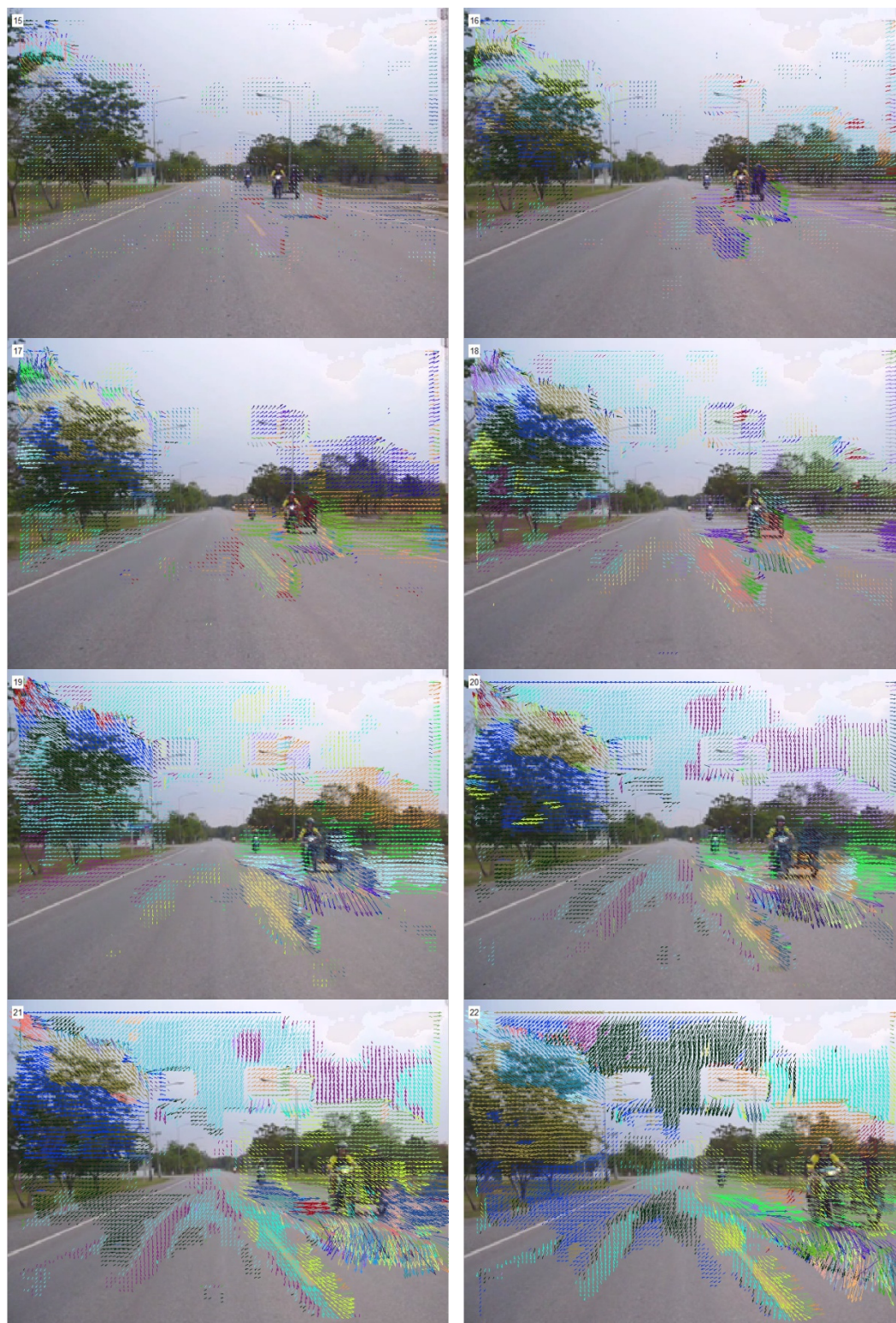
รูปที่ 3.34 ตัวอย่างผลการทดสอบการจับกลุ่มการไหลของแสงด้วย MSOFM แบบปรับปรุง ในขณะที่กล้องเคลื่อนที่เร็วและมีการสั่นน้อย
