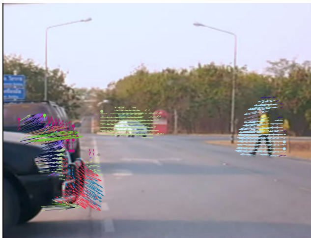
รูปที่ 3.18 ตัวอย่างของการจับกลุ่มการไหลของแสงที่เกิดจาก ภาพจริงด้วยการจับกลุ่มแบบปรับปรุง
