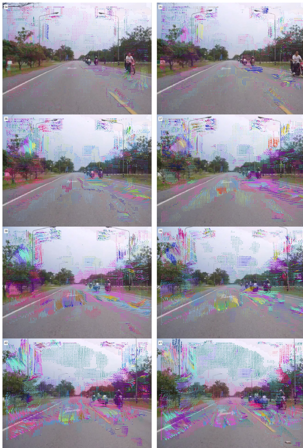
รูปที่ 3.33 ตัวอย่างผลการทดสอบการจับกลุ่มการไหลของแสงด้วย MSOFM แบบปรับปรุง ในขณะที่กล้องเคลื่อนที่เร็วมากและมีการสั่นน้อย
