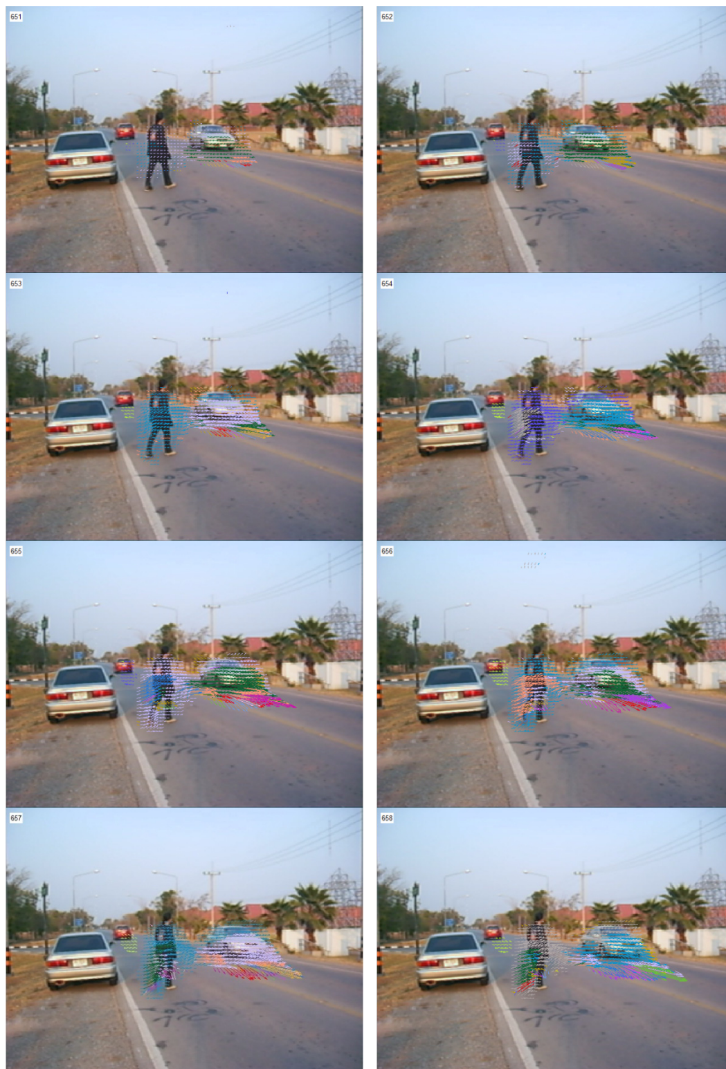
รูปที่ 3.32 ตัวอย่างผลการทดสอบการจับกลุ่มการไหลของแสงด้วย MSOFM แบบปรับปรุง ในขณะที่กล้องไม่มีการเคลื่อนที่ (ต่อ)
