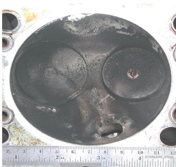
รูปที่ ๒.๔ แสดงบริเวณพื้นผิวด้านล่างของฝาสูบลำดับที่สี่ ของเครื่องยนต์ดีเซลระบบฉีดเชื้อเพลิงโดยอ้อม หลังจากที่ทำทดสอบใช้น้ำมันปาล์มดิบ เพื่อเป็นเชื้อเพลิงแทนน้ำมันดีเซล
