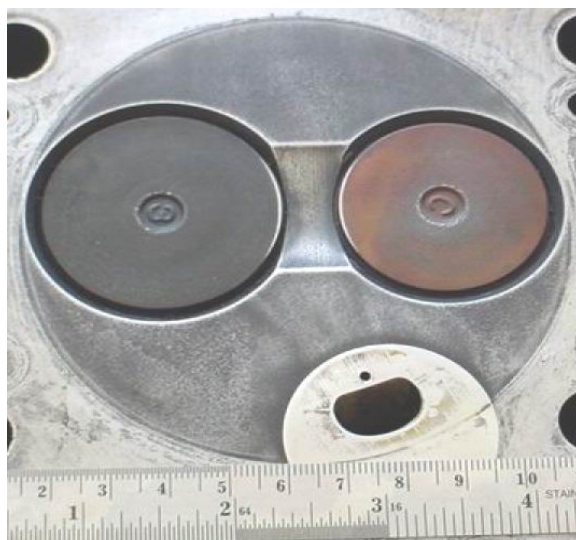
รูปที่ จ.2.3 แสดงบริเวณพื้นผิวด้านล่างของฝาสูบลำดับที่สาม ของเครื่องยนต์ดีเซลระบบฉีดเชื้อเพลิงโดยอ้อม ก่อนที่จะทำการทดสอบ
