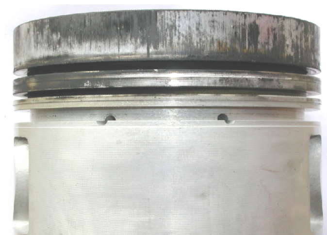
รูปที่ จ.3.3.1 แสดงบริเวณพื้นผิวด้านขวาของลูกสูบลำดับที่สาม ของเครื่องยนต์ดีเซลระบบฉีดเชื้อเพลิงโดยอ้อม หลังจากที่ทำทดสอบใช้น้ำมันปาล์มดิบ เพื่อเป็นเชื้อเพลิงแทนน้ำมันดีเซล
