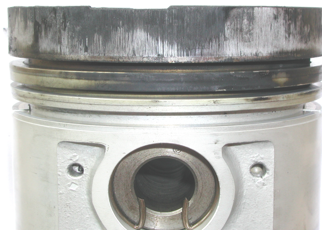
รูปที่ จ.3.3.3 แสดงบริเวณพื้นผิวด้านหน้าของลูกสูบลำดับที่สาม ของเครื่องยนต์ดีเซลระบบฉีดเชื้อเพลิงโดยอ้อม หลังจากที่ทำกาทดสอบใช้น้ำมันปาล์มดิบ เพื่อเป็นเชื้อเพลิงแทนน้ำมันดีเซล
