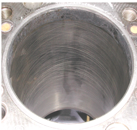
รูปที่ จ.1.2.1 แสดงบริเวณพื้นผิวด้านขวาของกระบอกสูบลำดับที่สอง ของเครื่องยนต์ดีเซลระบบฉีดเชื้อเพลิงโดยอ้อม หลังจากที่ทำทดสอบใช้น้ำมันปาล์มดิบ เพื่อเป็นเชื้อเพลิงแทนน้ำมันดีเซล
