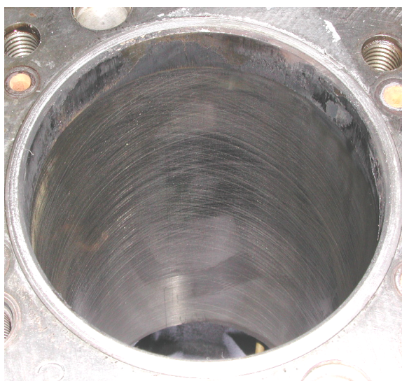
รูปที่ ฉ.1.1.1 แสดงบริเวณพื้นผิวด้านขวาของกระบอกสูบลำดับที่หนึ่ง ของเครื่องยนต์ดีเซลระบบฉีดเชื้อเพลิงโดยอ้อม หลังจากที่ทำทดสอบใช้น้ำมันปาล์มดิบ เพื่อเป็นเชื้อเพลิงแทนน้ำมันดีเซล
