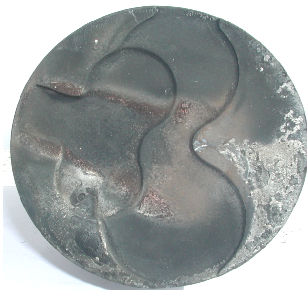
รูปที่ จ.3.3.5 แสดงบริเวณพื้นผิวด้านบนของลูกสูบลำดับที่สาม ของเครื่องยนต์ดีเซลระบบฉีดเชื้อเพลิงโดยอ้อม หลังจากที่ทำทดสอบใช้น้ำมันปาล์มดิบ เพื่อเป็นเชื้อเพลิงแทนน้ำมันดีเซล
