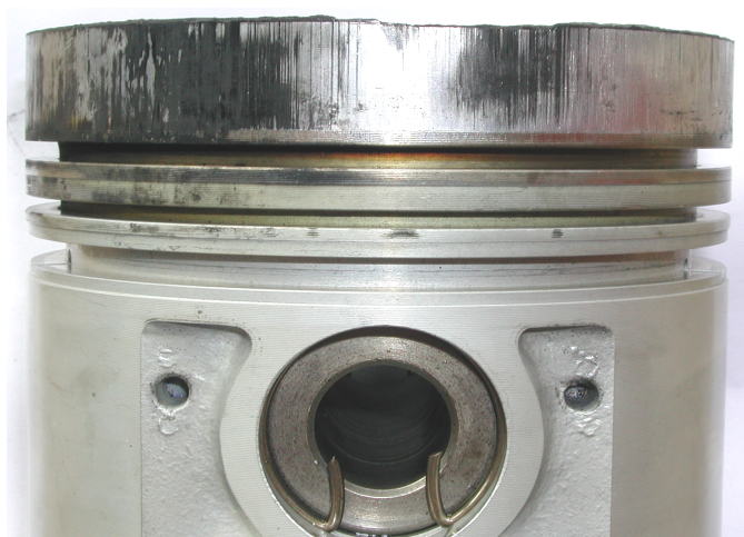
รูปที่ จ.3.3.4 แสดงบริเวณพื้นผิวด้านหลังของลูกสูบลำดับที่สาม ของเครื่องยนต์ดีเซลระบบฉีดเชื้อเพลิงโดยอ้อม หลังจากที่ทำทดสอบใช้น้ำมันปาล์มดิบ เพื่อเป็นเชื้อเพลิงแทนน้ำมันดีเซล
