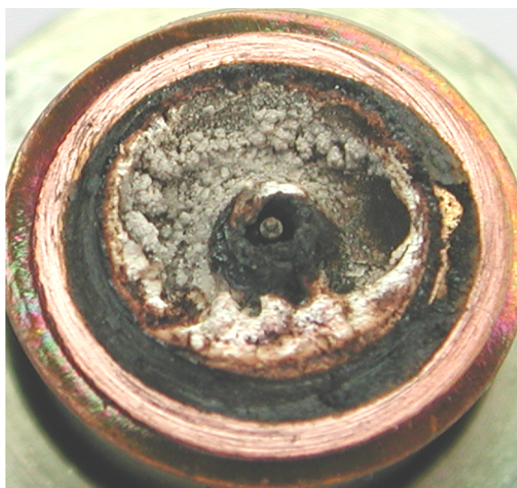
รูปที่ จ.4.4.1 แสดงบริเวณพื้นผิวด้านบนของหัวฉีดลำดับที่สี่ ของเครื่องยนต์ดีเซลระบบฉีดเชื้อเพลิงโดยอ้อม หลังจากที่ทำกาทดสอบใช้น้ำมันปาล์มดิบเพื่อเป็นเชื้อเพลิงแทนน้ำมันดีเซล
