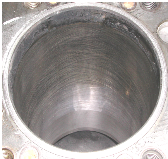
รูปที่ จ.1.2.4 แสดงบริเวณพื้นผิวด้านหลังของกระบอกสูบลำดับที่สอง ของเครื่องยนต์ดีเซลระบบฉีดเชื้อเพลิงโดยอ้อม หลังจากที่ทำทดสอบใช้น้ำมันปาล์มดิบ เพื่อเป็นเชื้อเพลิงแทนน้ำมันดีเซล
