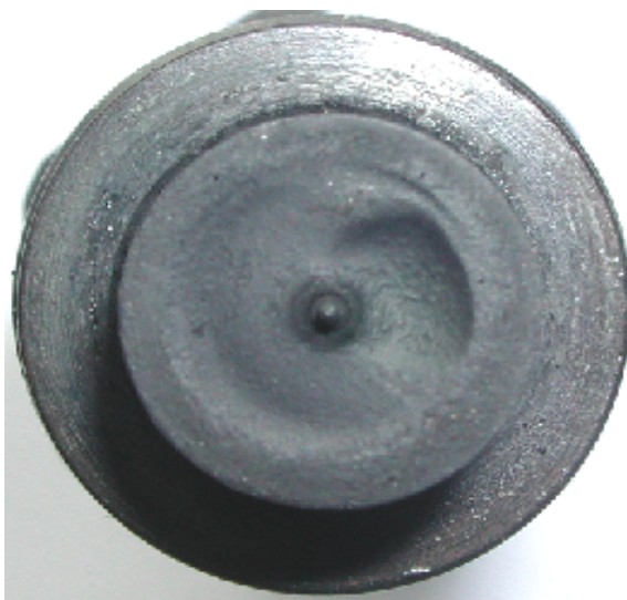
รูปที่ ข.4.1 แสดงบริเวณพื้นผิวด้านบนของหัวฉีดลำดับที่หนึ่ง ของเครื่องยนต์ดีเซลระบบฉีดเชื้อเพลิงโดยอ้อม หลังจากผ่านการใช้งานมาแล้ว โดยการใช้ น้ำมันดีเซลเป็นเชื้อเพลิง
