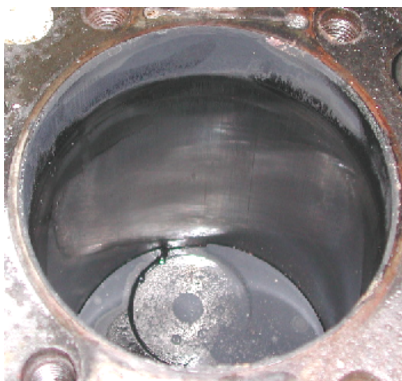
รูปที่ ข.1.1 แสดงบริเวณพื้นผิวด้านขวาของกระบอกสูบลำดับที่หนึ่ง ของเครื่องยนต์ดีเซลระบบฉีดเชื้อเพลิงโดยอ้อม หลังจากที่ผ่านมาการใช้งานมาแล้ว โดยการใช้ น้ำมันดีเซลเป็นเชื้อเพลิง
