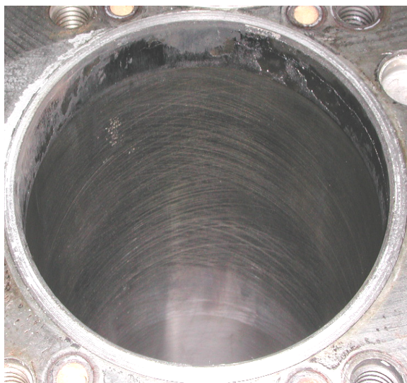
รูปที่ จ.1.3.4 แสดงบริเวณพื้นผิวด้านหลังของกระบอกสูบลำดับที่สาม ของเครื่องยนต์ดีเซลระบบฉีดเชื้อเพลิงโดยอ้อม หลังจากที่ทำทดสอบใช้น้ำมันปาล์มดิบ เพื่อเป็นเชื้อเพลิงแทนน้ำมันดีเซล
