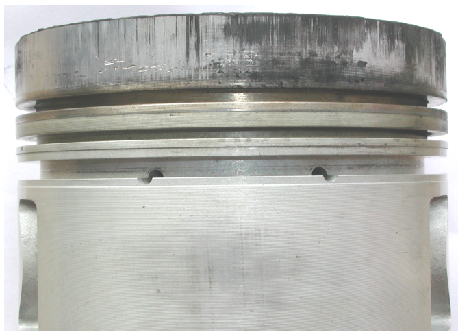
รูปที่ จ.3.3.2 แสดงบริเวณพื้นผิวด้านซ้ายของลูกสูบลำดับที่สาม ของเครื่องยนต์ดีเซลระบบฉีดเชื้อเพลิงโดยอ้อม หลังจากที่ทำกาทดสอบใช้น้ำมันปาล์มดิบ เพื่อเป็นเชื้อเพลิงแทนน้ำมันดีเซล
