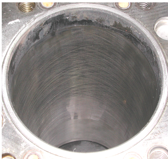
รูปที่ จ.1.1.4 แสดงบริเวณพื้นผิวด้านหลังของกระบอกสูบลำดับที่หนึ่ง ของเครื่องยนต์ดีเซลระบบฉีดเชื้อเพลิงโดยอ้อม หลังจากที่ทำทดสอบใช้น้ำมันปาล์มดิบ เพื่อเป็นเชื้อเพลิงแทนน้ำมันดีเซล
