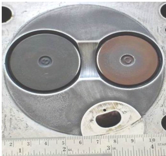
รูปที่ จ.2.2 แสดงบริเวณพื้นผิวด้านล่างของฝาสูบลำดับที่สอง ของเครื่องยนต์ดีเซลระบบฉีดเชื้อเพลิงโดยอ้อม ก่อนที่จะทำการทดสอบ
