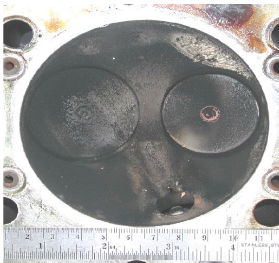
รูปที่ ๒.๓ แสดงบริเวณพื้นผิวด้านล่างของฝาสูบลำดับที่สาม ของเครื่องยนต์ดีเซลระบบฉีดเชื้อเพลิงโดยอ้อม หลังจากที่ทำทดสอบใช้น้ำมันปาล์มดิบ เพื่อเป็นเชื้อเพลิงแทนน้ำมันดีเซล
