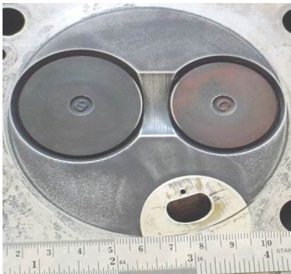
รูปที่ จ.2.4 แสดงบริเวณพื้นผิวด้านล่างของฟลูอิโดสลับที่สี่ ของเครื่องยนต์ดีเซระบบฉีดเชื้อเพลิง โดยอ้อม ก่อนที่จะทำการทดสอบ
