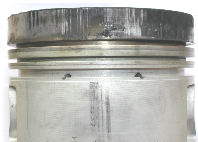
รูปที่ จ.3.4.2 แสดงบริเวณพื้นผิวด้านซ้ายของลูกสูบลำดับที่สี่ ของเครื่องยนต์ดีเซลระบบฉีดเชื้อเพลิงโดยอ้อม หลังจากที่ทำการศึกษาทดสอบใช้น้ำมันปาล์มดิบ เพื่อเป็นเชื้อเพลิงแทนน้ำมันดีเซล
