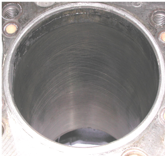
รูปที่ จ.1.3.2 แสดงบริเวณพื้นผิวด้านซ้ายของกระบอกสูบลำดับที่สาม ของเครื่องยนต์ดีเซลระบบฉีดเชื้อเพลิงโดยอ้อม หลังจากที่ทำกรทดสอบใช้น้ำมันปาล์มดิบ เพื่อเป็นเชื้อเพลิงแทนน้ำมันดีเซล
