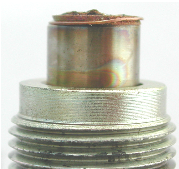
รูปที่ จ.4.1.2 แสดงบริเวณพื้นผิวด้านข้างของหัวฉีดลำดับที่หนึ่ง ของเครื่องยนต์ดีเซลระบบฉีดเชื้อเพลิงโดยอ้อม หลังจากที่ทำทดสอบใช้น้ำมันปาล์มดิบ เพื่อเป็นเชื้อเพลิงแทนน้ำมันดีเซล
