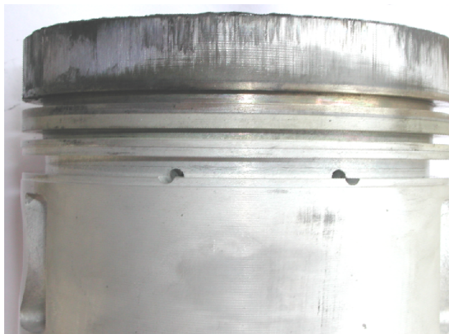
รูปที่ ๓.๓.๑.๒ แสดงบริเวณพื้นผิวด้านซ้ายของลูกสูบลำดับที่หนึ่ง ของเครื่องยนต์ดีเซลระบบฉีดเชื้อเพลิงโดยอ้อม หลังจากทำการทดสอบใช้น้ำมันปาล์มดิบ เพื่อเป็นเชื้อเพลิงแทนน้ำมันดีเซล
