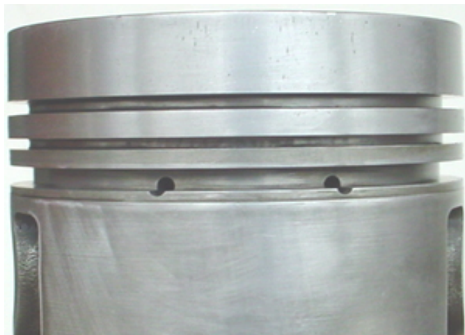
รูปที่ จ.3.1 แสดงบริเวณพื้นผิวด้านขวาของลูกสูบลำดับที่หนึ่ง ของเครื่องยนต์ดีเซลระบบฉีดเชื้อเพลิงโดยอ้อม ก่อนที่จะทำการทดสอบ
