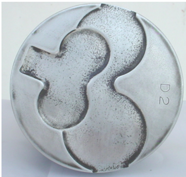
รูปที่ จ.3.5 แสดงบริเวณพื้นผิวด้านบนของลูกสูบลำดับที่หนึ่ง ของเครื่องยนต์ดีเซลระบบฉีดเชื้อเพลิงโดยอ้อม ก่อนที่จะทำการทดสอบ
