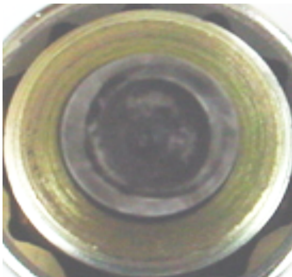
รูปที่ จ.4.2.1 แสดงบริเวณพื้นผิวด้านบนของหัวฉีดลำดับที่สอง ของเครื่องยนต์ดีเซลระบบฉีดเชื้อเพลิงโดยอ้อม ก่อนที่จะทำการทดสอบ
