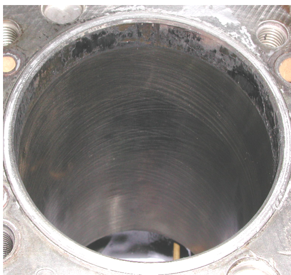
รูปที่ จ.1.4.1 แสดงบริเวณพื้นผิวด้านขวาของกระบอกสูบลำดับที่สี่ ของเครื่องยนต์ดีเซลระบบฉีดเชื้อเพลิงโดยอ้อม หลังจากที่ทำทดสอบใช้น้ำมันปาล์มดิบ เพื่อเป็นเชื้อเพลิงแทนน้ำมันดีเซล
