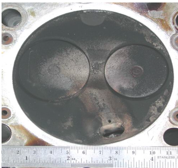
รูปที่ ๒.๑ แสดงบริเวณพื้นผิวด้านล่างของฝาสูบลำดับที่หนึ่ง ของเครื่องยนต์ดีเซลระบบฉีดเชื้อเพลิงโดยอ้อม หลังจากที่ทำกาทดสอบใช้น้ำมันปาล์มดิบ เพื่อเป็นเชื้อเพลิงแทนน้ำมันดีเซล
