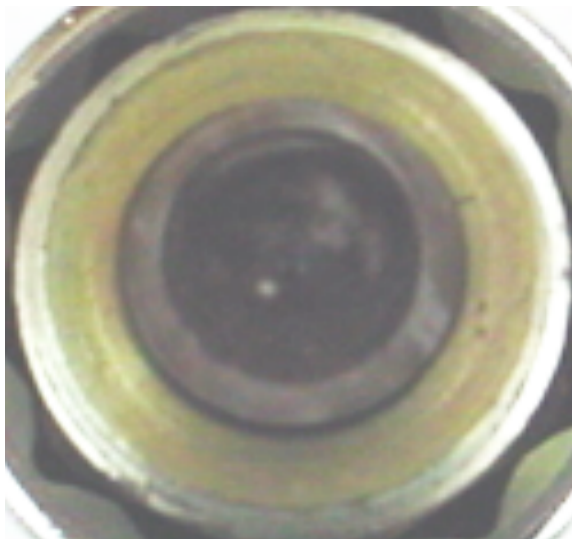
รูปที่ จ.4.4.1 แสดงบริเวณพื้นผิวด้านบนของหัวฉีดลำดับที่สี่ ของเครื่องยนต์ดีเซลระบบฉีดเชื้อเพลิงโดยอ้อม ก่อนที่จะทำการทดสอบ
