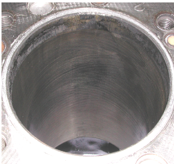
รูปที่ จ.1.4.2 แสดงบริเวณพื้นผิวด้านซ้ายของกระบอกสูบลำดับที่สี่ ของเครื่องยนต์ดีเซลระบบฉีดเชื้อเพลิงโดยอ้อม หลังจากที่ทำกรทดสอบใช้น้ำมันปาล์มดิบ เพื่อเป็นเชื้อเพลิงแทนน้ำมันดีเซล
