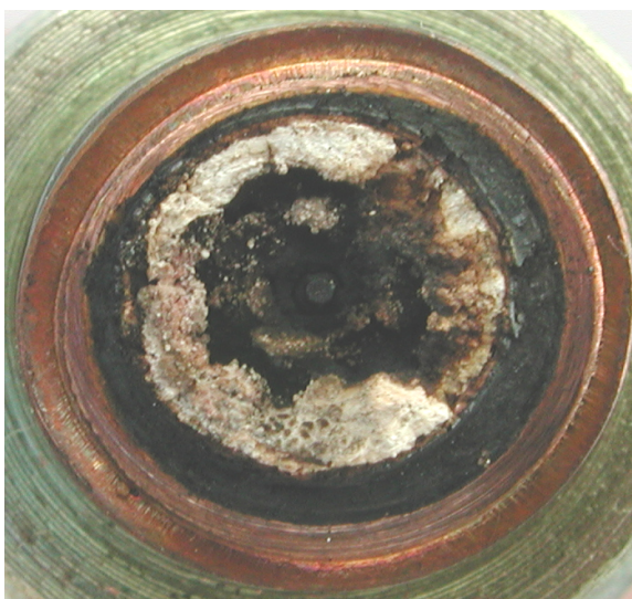
รูปที่ จ.4.2.1 แสดงบริเวณพื้นผิวด้านบนของหัวฉีดลำดับที่สอง ของเครื่องยนต์ดีเซลระบบฉีดเชื้อเพลิงโดยอ้อม หลังจากที่ทำทดสอบใช้น้ำมันปาล์มดิบ เพื่อเป็นเชื้อเพลิงแทนน้ำมันดีเซล
