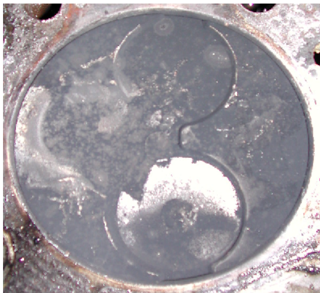
รูปที่ ข.3.1 แสดงบริเวณพื้นผิวด้านบนของลูกสูบลำดับที่หนึ่ง ของเครื่องยนต์ดีเซลระบบฉีดเชื้อเพลิงโดยอ้อม หลังจากผ่านการใช้งานมาแล้ว โดยการใช้ น้ำมันดีเซลเป็นเชื้อเพลิง
