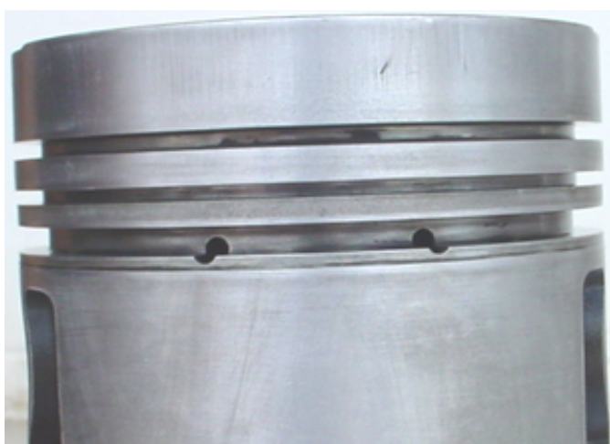
รูปที่ จ.3.2 แสดงบริเวณพื้นผิวด้านซ้ายของลูกสูบลำดับที่หนึ่ง ของเครื่องยนต์ดีเซลระบบฉีดเชื้อเพลิงโดยอ้อม ก่อนที่จะทำการทดสอบ
