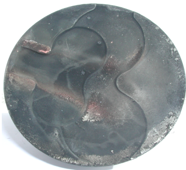
รูปที่ จ.3.2.5 แสดงบริเวณพื้นผิวด้านบนของลูกสูบลำดับที่สอง ของเครื่องยนต์ดีเซลระบบฉีดเชื้อเพลิงโดยอ้อม หลังจากที่ทำทดสอบใช้น้ำมันปาล์มดิบ เพื่อเป็นเชื้อเพลิงแทนน้ำมันดีเซล
