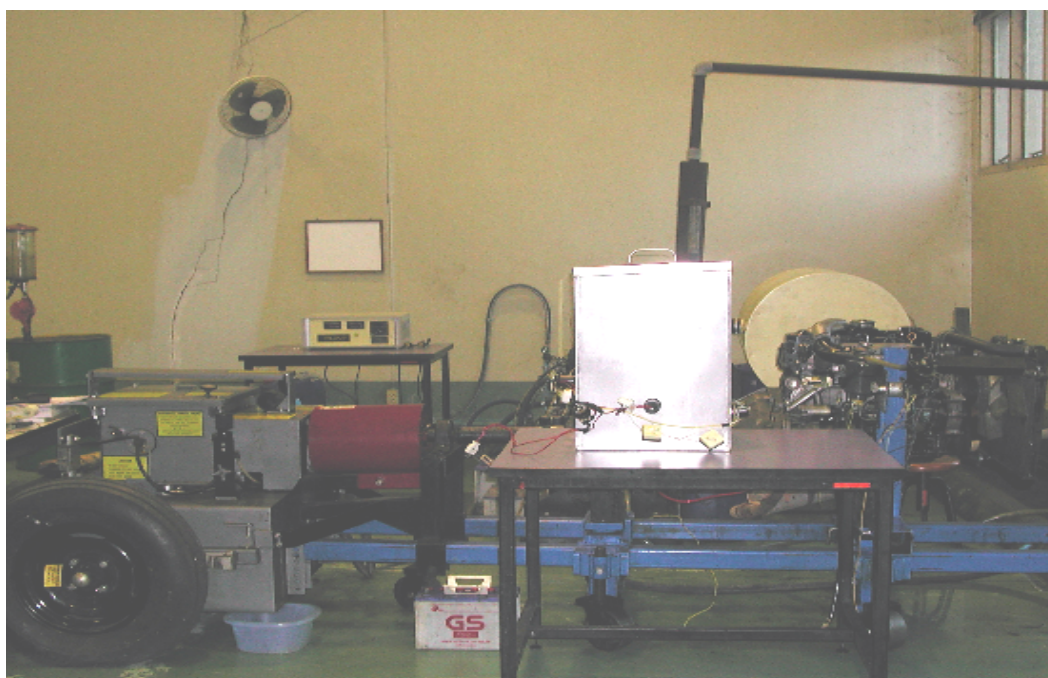
รูปที่ 4.1 แสดงลักษณะการติดตั้งเครื่องยนต์บนแท่นทดสอบไดนาโมมิเตอร์ พร้อมทั้งการจัดวางอุปกรณ์ต่างๆ ที่จำเป็นต้องใช้ในระหว่างทำการทดสอบ ให้อยู่ในสภาพพร้อมที่จะทำการทดสอบ
