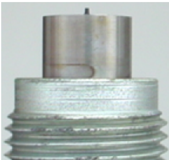
รูปที่ จ.4.4.2 แสดงบริเวณพื้นผิวด้านข้างของหัวฉีดลำดับที่สี่ ของเครื่องยนต์ดีเซลระบบฉีดเชื้อเพลิงโดยอ้อม ก่อนที่จะทำการทดสอบ
