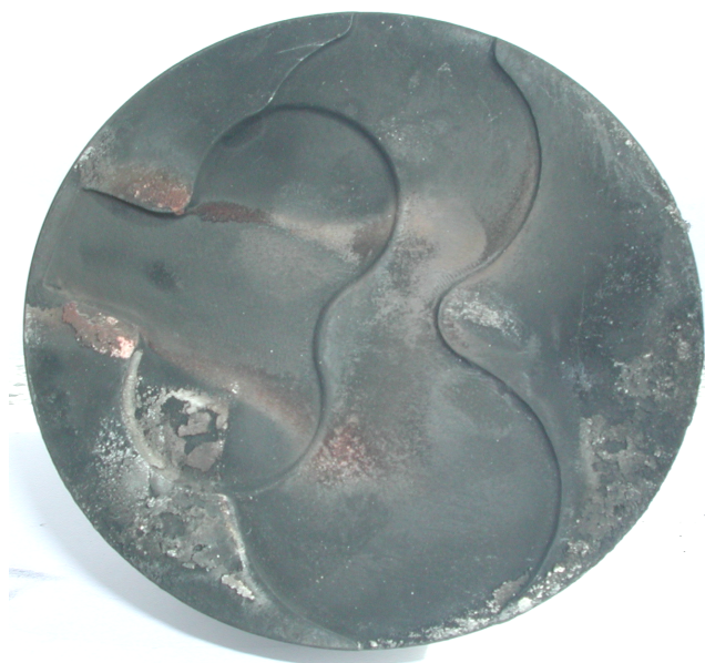
รูปที่ ๓.๓.๔.๕ แสดงบริเวณพื้นผิวด้านบนของลูกสูบลำดับที่สี่ ของเครื่องยนต์ดีเซลระบบฉีดเชื้อเพลิงโดยอ้อม หลังจากทำการทดสอบใช้น้ำมันปาล์มดิบ เพื่อเป็นเชื้อเพลิงแทนน้ำมันดีเซล
