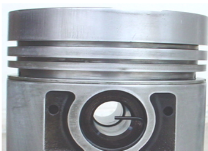
รูปที่ จ.3.4 แสดงบริเวณพื้นผิวด้านหลังของลูกสูบลำดับที่หนึ่ง ของเครื่องยนต์ดีเซลระบบฉีดเชื้อเพลิงโดยอ้อม ก่อนที่จะทำการทดสอบ
