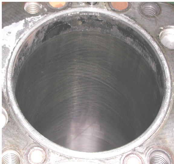
รูปที่ จ.1.4.4 แสดงบริเวณพื้นผิวด้านหลังของกระบอกสูบลำดับที่สี่ ของเครื่องยนต์ดีเซลระบบฉีดเชื้อเพลิงโดยอ้อม หลังจากทำการทดสอบใช้น้ำมันปาล์มดิบ เพื่อเป็นเชื้อเพลิงแทนน้ำมันดีเซล
