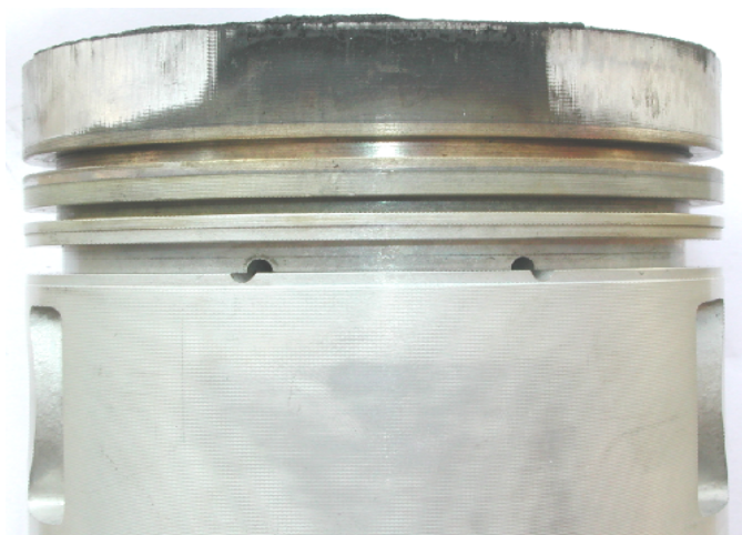
รูปที่ จ.3.2.2 แสดงบริเวณพื้นผิวด้านซ้ายของลูกสูบลำดับที่สอง ของเครื่องยนต์ดีเซลระบบฉีดเชื้อเพลิงโดยอ้อม หลังจากทำการทดสอบใช้น้ำมันปาล์มดิบ เพื่อเป็นเชื้อเพลิงแทนน้ำมันดีเซล
