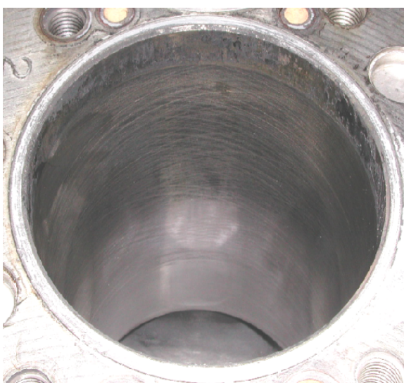
รูปที่ จ.1.4.3 แสดงบริเวณพื้นผิวด้านหน้าของกระบอกสูบลำดับที่สี่ ของเครื่องยนต์ดีเซลระบบฉีดเชื้อเพลิงโดยอ้อม หลังจากที่ทำกรทดสอบใช้น้ำมันปาล์มดิบ เพื่อเป็นเชื้อเพลิงแทนน้ำมันดีเซล
