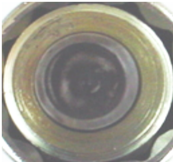
รูปที่ จ.4.3.1 แสดงบริเวณพื้นผิวด้านบนของหัวฉีดลำดับที่สาม ของเครื่องยนต์ดีเซลระบบฉีดเชื้อเพลิงโดยอ้อม ก่อนที่จะทำการทดสอบ
