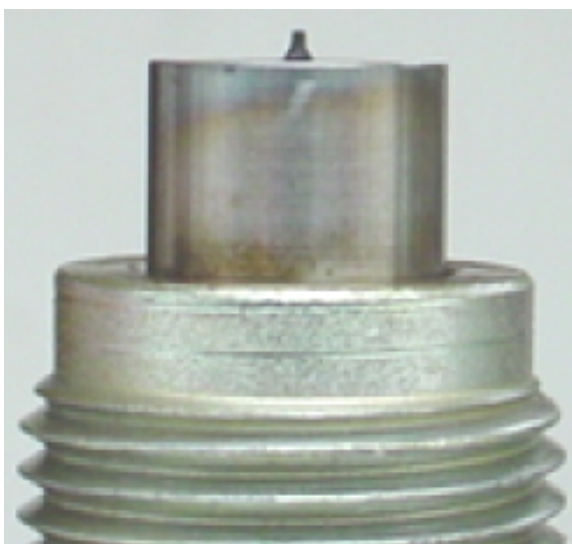
รูปที่ จ.4.2.2 แสดงบริเวณพื้นผิวด้านข้างของหัวฉีดลำดับที่สอง ของเครื่องยนต์ดีเซลระบบฉีดเชื้อเพลิงโดยอ้อม ก่อนที่จะทำการทดสอบ
