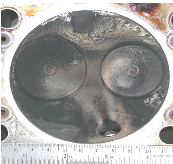
รูปที่ ๒.๒ แสดงบริเวณพื้นผิวด้านล่างของฝาสูบลำดับที่สอง ของเครื่องยนต์ดีเซลระบบฉีดเชื้อเพลิงโดยอ้อม หลังจากที่ทำกาทดสอบใช้น้ำมันปาล์มดิบ เพื่อเป็นเชื้อเพลิงแทนน้ำมันดีเซล
