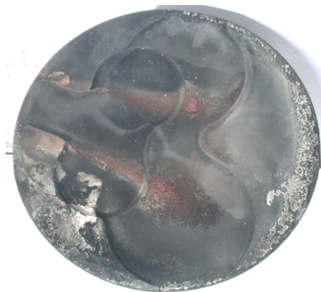
รูปที่ จ.3.1.5 แสดงบริเวณพื้นผิวด้านบนของลูกสูบลำดับที่หนึ่ง ของเครื่องยนต์ดีเซลระบบฉีดเชื้อเพลิงโดยอ้อม หลังจากที่ทำทดสอบใช้น้ำมันปาล์มดิบ เพื่อเป็นเชื้อเพลิงแทนน้ำมันดีเซล
