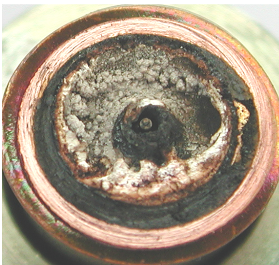
รูปที่ จ.4.3.1 แสดงบริเวณพื้นผิวด้านบนของหัวฉีดลำดับที่สาม ของเครื่องยนต์ดีเซลระบบฉีดเชื้อเพลิงโดยอ้อม หลังจากที่ทำทดสอบใช้น้ำมันปาล์มดิบ เพื่อเป็นเชื้อเพลิงแทนน้ำมันดีเซล
