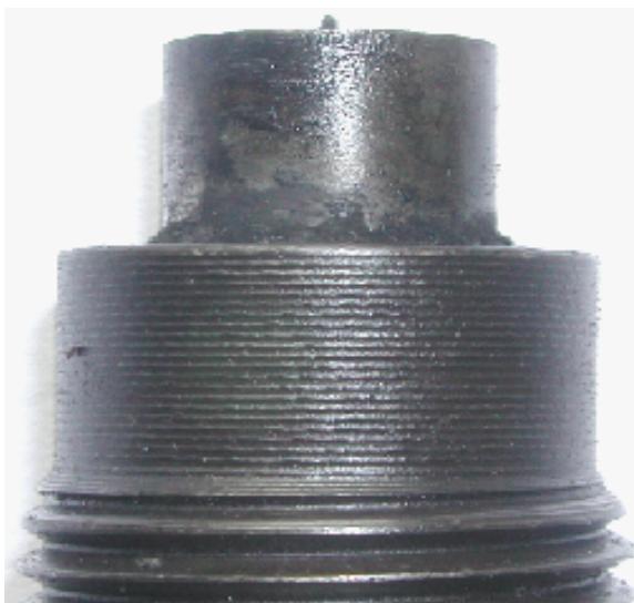
รูปที่ ข.4.2 แสดงบริเวณพื้นผิวด้านข้างของหัวฉีดลำดับที่หนึ่ง ของเครื่องยนต์ดีเซลระบบฉีดเชื้อเพลิงโดยอ้อม หลังจากผ่านการใช้งานมาแล้ว โดยการใช้ น้ำมันดีเซลเป็นเชื้อเพลิง
