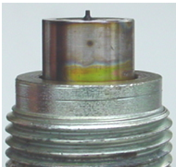
รูปที่ จ.4.1.2 แสดงบริเวณพื้นผิวด้านข้างของหัวฉีดลำดับที่หนึ่ง ของเครื่องยนต์ดีเซลระบบฉีดเชื้อเพลิงโดยอ้อม ก่อนที่จะทำการทดสอบ
