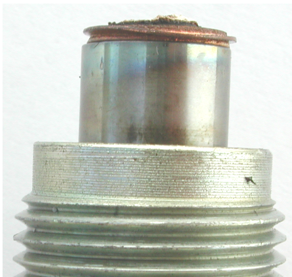
รูปที่ จ.4.2.2 แสดงบริเวณพื้นผิวด้านข้างของหัวฉีดลำดับที่สอง ของเครื่องยนต์ดีเซลระบบฉีดเชื้อเพลิงโดยอ้อม หลังจากที่ทำทดสอบใช้น้ำมันปาล์มดิบ เพื่อเป็นเชื้อเพลิงแทนน้ำมันดีเซล
