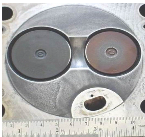
รูปที่ จ.2.1 แสดงบริเวณพื้นผิวด้านล่างของฝาสูบลำดับที่หนึ่ง ของเครื่องยนต์ดีเซลระบบฉีดเชื้อเพลิงโดยอ้อม ก่อนที่จะทำการทดสอบ
