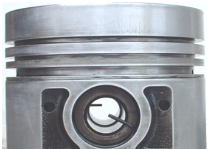
รูปที่ จ.3.3 แสดงบริเวณพื้นผิวด้านหน้าของลูกสูบลำดับที่หนึ่ง ของเครื่องยนต์ดีเซลระบบฉีดเชื้อเพลิงโดยอ้อม ก่อนที่จะทำการทดสอบ
