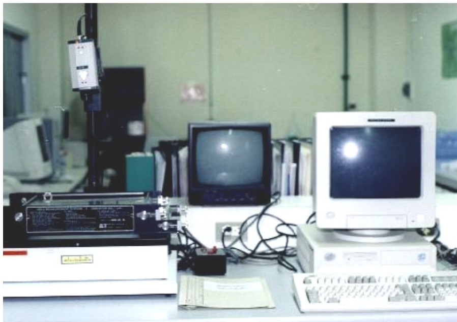
ภาพที่ 17 แสดงลักษณะและส่วนประกอบของเครื่องวัดพื้นที่ใบ Delta-T image analysis system รุ่น 6322-002 พร้อม monitors และกล้องถ่ายภาพ
