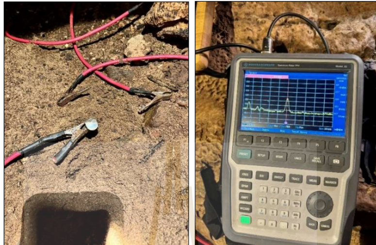
รูปที่ 4.15 การวัดค่าประสิทธิภาพการรับสัญญาณของอิเล็กทรอนิกส์ ผ่านคลื่นความถี่ 350 kHz ของแท่งอิเล็กทรอนิกส์รูปแบบอ้างอิง#1 ยี่ห้อ Decathlon
