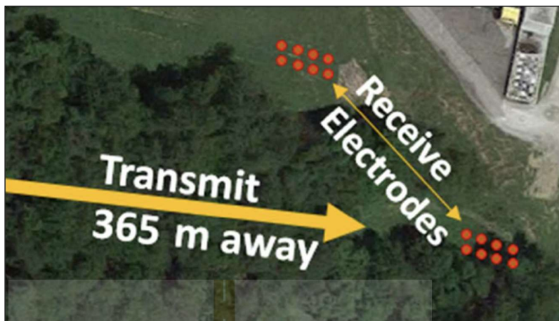
รูปที่ 2.11 แสดงภาพถ่ายดาวเทียมของพื้นที่รับสัญญาณ จุดสีส้มระบุตำแหน่งของแท่งอิเล็กโทรด ที่มา: Damiano et al. (2016)
