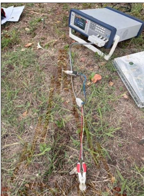
รูปที่ 4.5 แสดงการทดลองวัดค่าความต้านทานของอิเล็กโทรด
