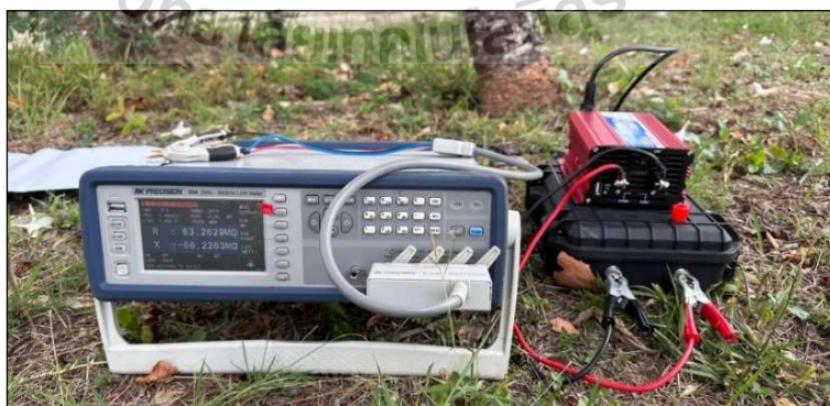
รูปที่ 4.4 เครื่องมือ รุ่น BK Precision 894 ที่ใช้ในการทดลองวัดค่าความต้านทานของอิเล็กทรอนิกส์
