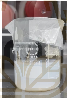
รูปที่ 4.1 ลักษณะเจลของสารประกอบไทเทเนียมไดออกไซด์ ที่ได้จากการสังเคราะห์ด้วยกระบวนการโซลเจล
